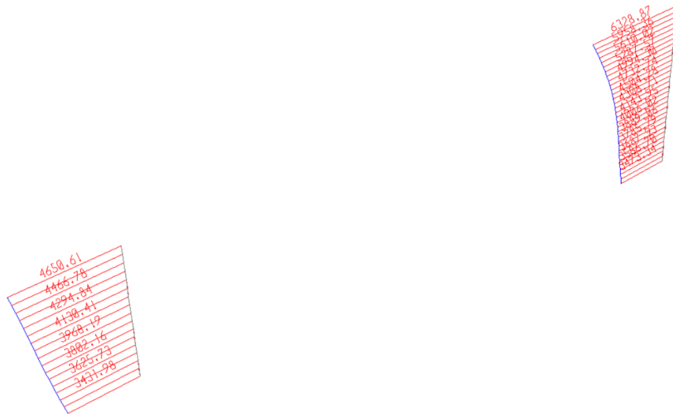
Figura 243 Diagrama de Momentos Longitudinales por Sismo Transversal - Puente Bermúdez
