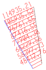
Figura 210 Diagrama de Momentos Longitudinales por Sismo Longitudinal - Puente Bermúdez
