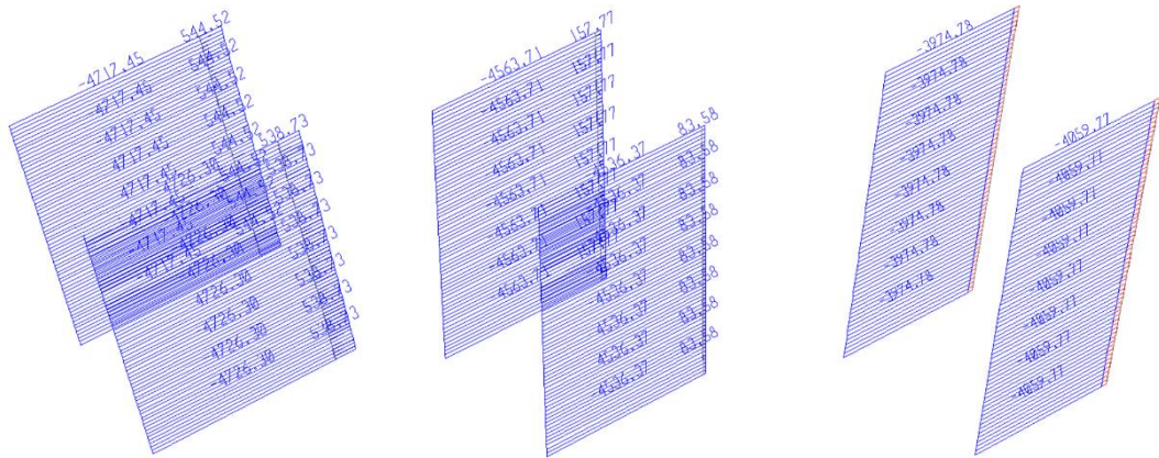
Figura 79 Diagrama de Carga Axial por Envoltorio de Diseño – Puente Vía a Minca
