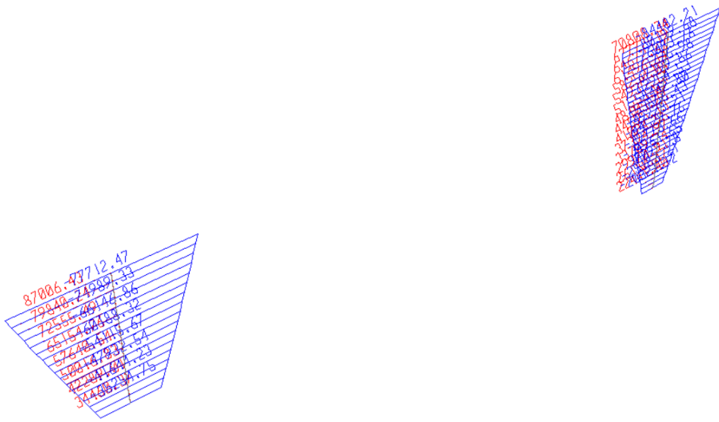
Figura 246 Diagrama de Momentos Longitudinales por Envolvente de Diseño - Punte Bermúdez
