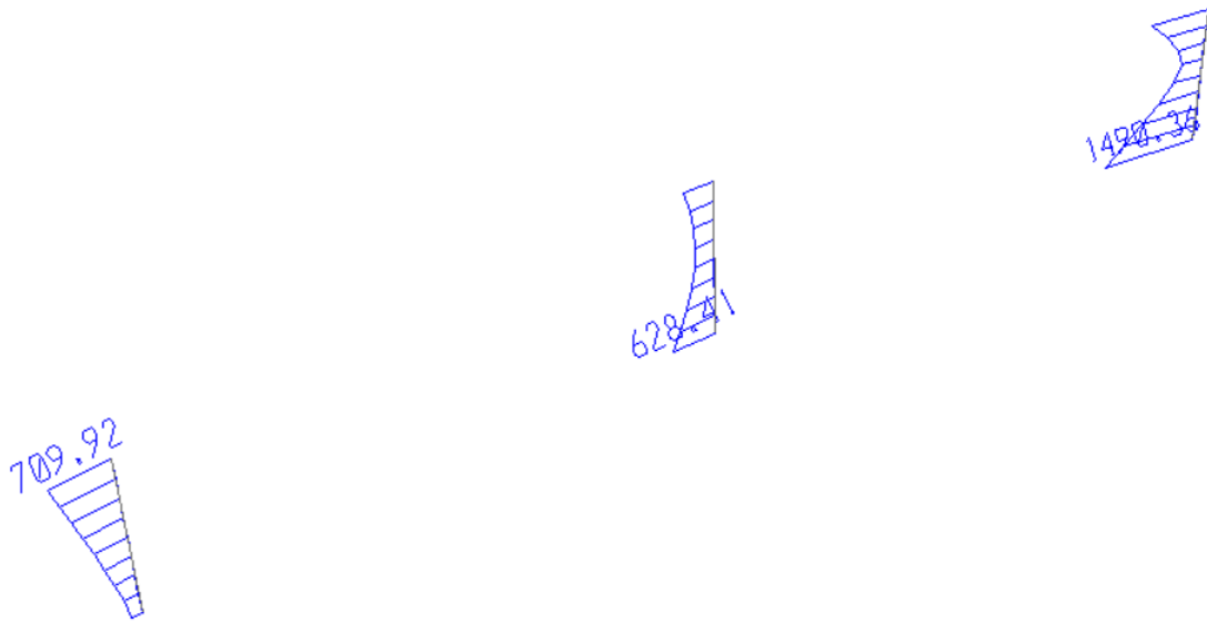
Figura 99 Diagrama de Momentos Longitudinales por Sismo Transversal - Puente Vía a Minca
