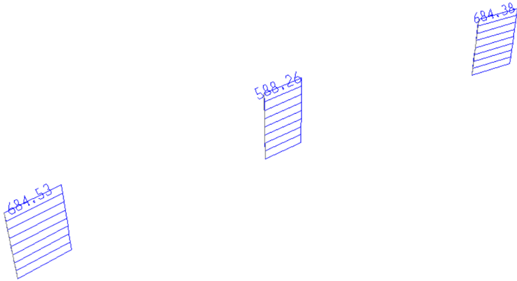
Figura 64 Diagrama de Carga Axial por Sismo Longitudinal – Puente Vía a Minca
