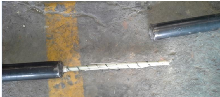
Figura 10-13 Modo de falla barra GFRP V2. Fuente el autor
