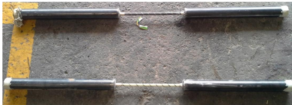
Figura 4-9 Barras de FRP con tubos metálicos en sus extremos. Fuente: el autor
