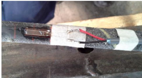
1.) Instrumentación de la barra de carbono CFRP
