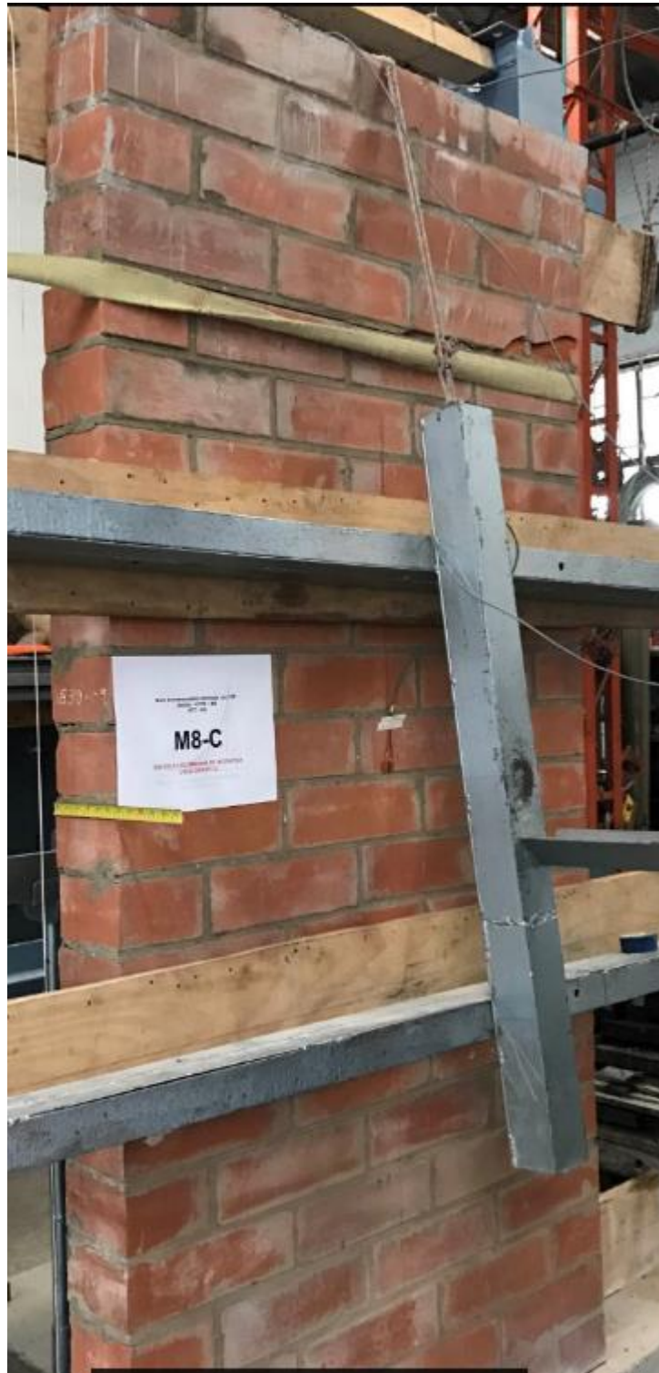
2.) Falla por separación entre ladrillos
