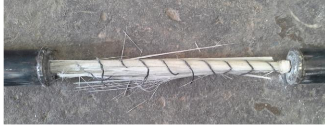
Figura 5-4 Falla típica de una barra de GFRP. Fuente: el autor
