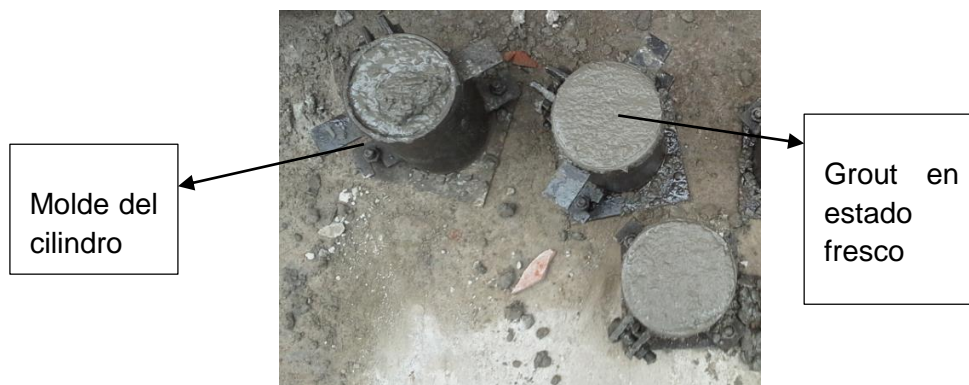
Figura 4-3 Cilindros de mortero de relleno. Fuente: el autor
