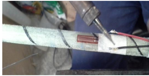
2.) Instrumentación de la barra de vidrio GFRP
