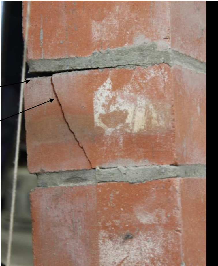
Figura 7-5 Falla típica en los muros de mampostería reforzados con barras de GFRP. Fuente: el autor.
