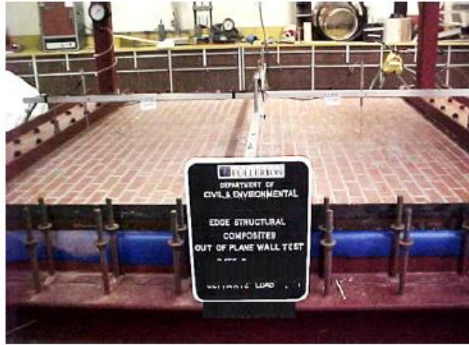
Figura 2-1 Montaje del ensayo realizado. Tomado: Ayman S. Mosallam. 2006
