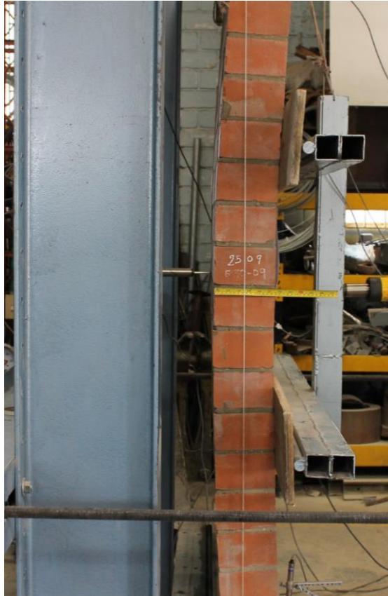
2.) Carga aplicada al muro M1-G
