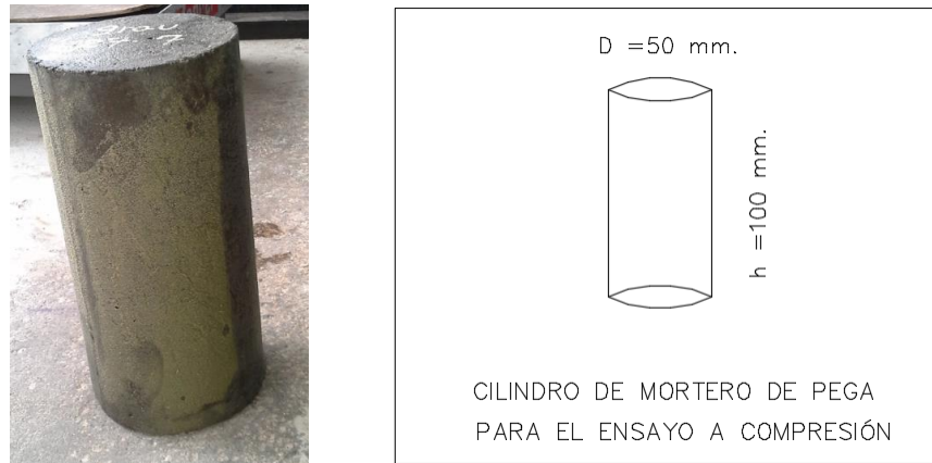
Figura 4-1 Cilindros de mortero de pega. Fuente: el autor
