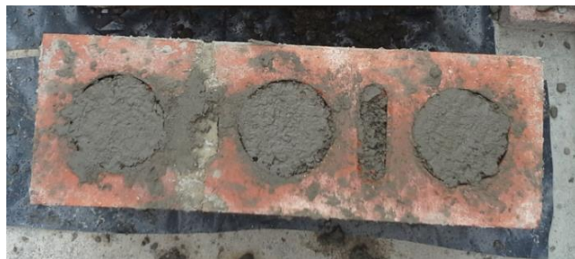
Figura 4-6 Muretes de mampostería con inyección de grout. Fuente: el autor
