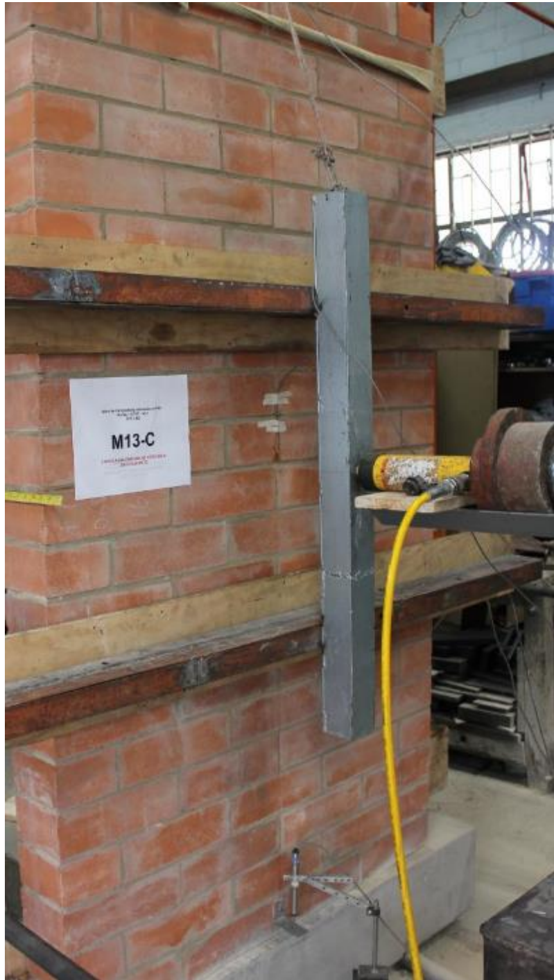
1.) Montaje del muro M13-C
