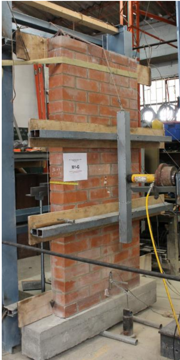
1.) Montaje en el marco de prueba del muro M1-G
