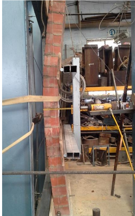
2.) Deformada del muro M11-C.
