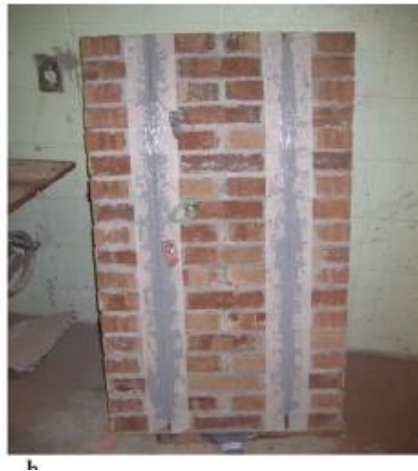
Figura 2-2 Muro a escala real reforzado externamente con barras de FRP. Tomado: Nestore Galati, Gustavo Tumialan, Antonio Nanni. 2005.
