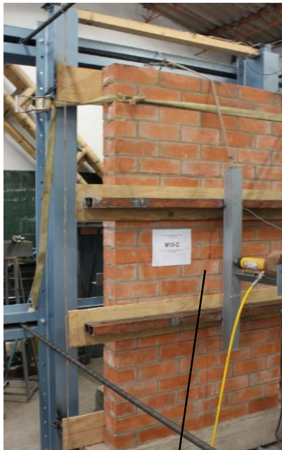
Strain gauge, en la cara de compresión
