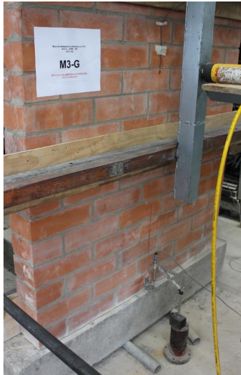
1.) Montaje en el marco de prueba del muro M3-G
