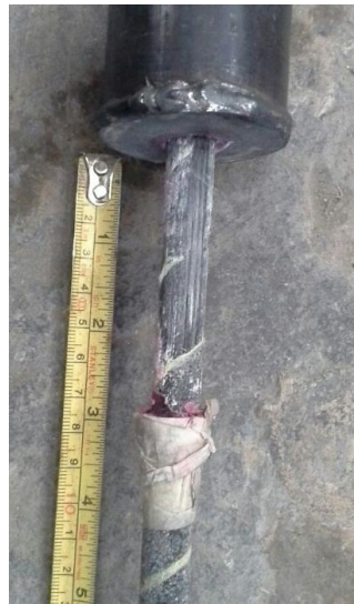
Figura 5-5 Falla típica barra de CFRP. Fuente: el autor
