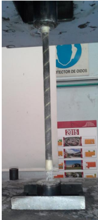
Figura 10-18 Modo de falla barra CFRP V3. Fuente el autor
