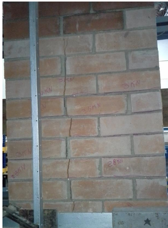
2.) Fisuras por aplastamiento en la cara de compresión
