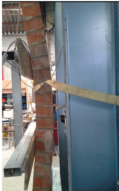
3.) Deformada del muro M11-C
