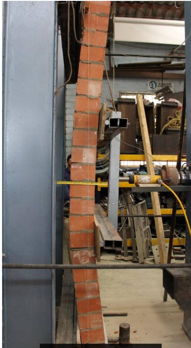
3.) Deformada del muro M7-G
