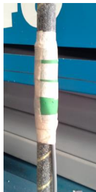
3.) Protección de la instrumentación de la barra de carbono CFRP
