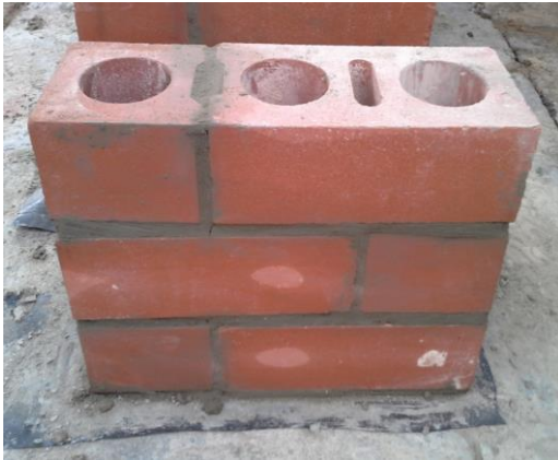
Figura 4-5 Muretes de mampostería sin inyección de grout de relleno. Fuente: el autor
