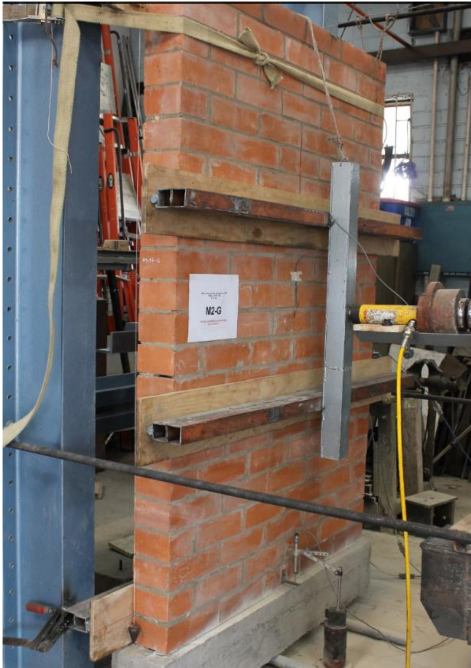
1.) Montaje en marco de prueba muro M2-G
