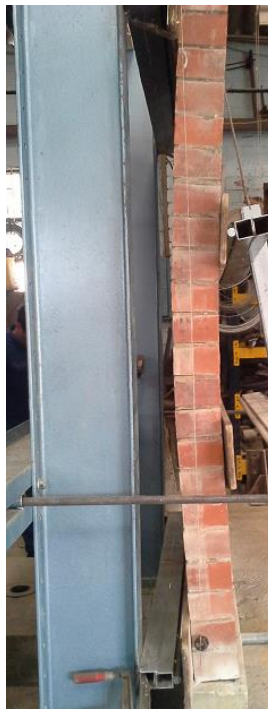
3.) Deformada bajo carga del muro M16-S.
