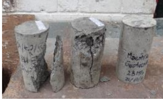
Fotografía 6. Estado de rotura en algunos especímenes ensayados a compresión. Fuente. Elaboración propia, durante el proceso evaluación de resistencia en los especímenes.
