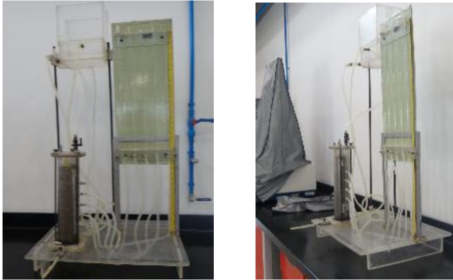
Figura 86. Montaje equipo para medición en cabeza variable. Fuente: (ECI. 2017). Laboratorio de Geotecnia.
