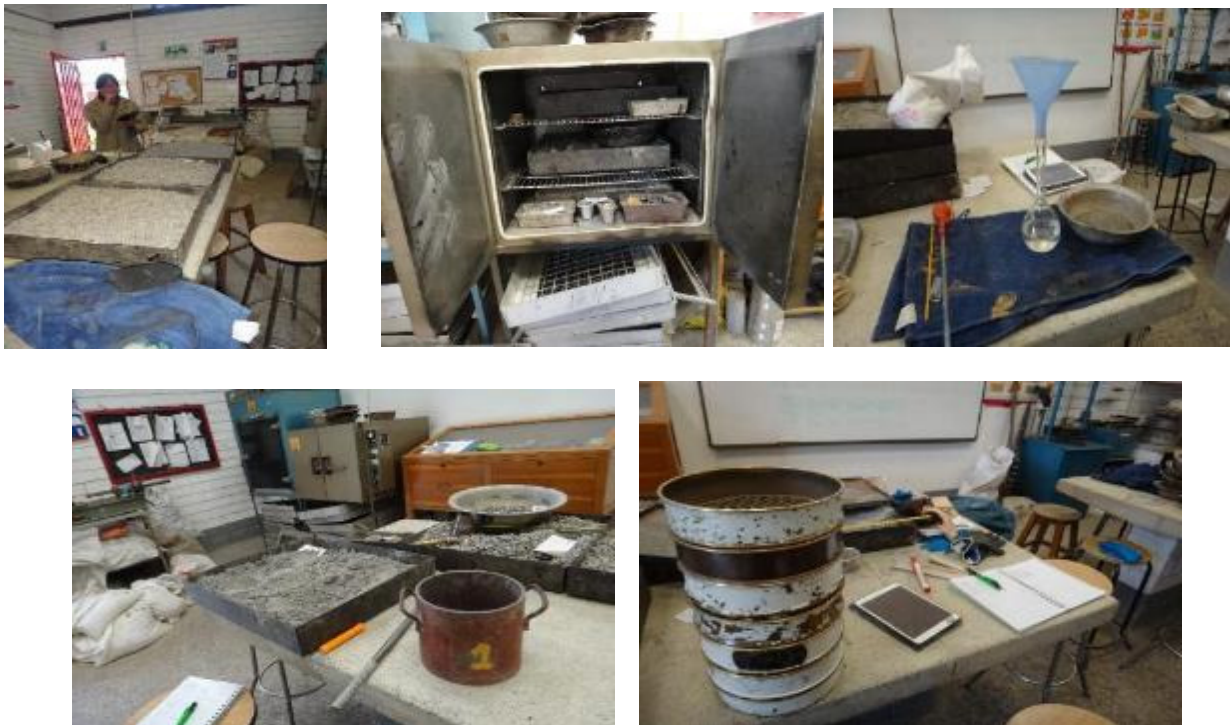
Figura 160. Actividades y elementos utilizados para caracterizar los materiales de la mezcla. Fuente: Elaboración Propia, proceso de caracterización de los agregados de la mezcla, laboratorio ECI.
