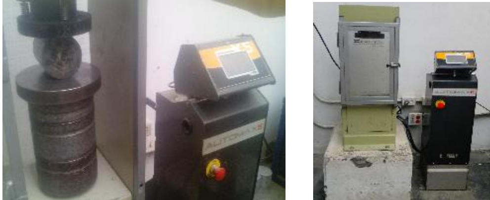
Fotografía 11. Corte del espécimen y toma de datos de profundidad de penetración del agua Fuente: Elaboración propia, tensión indirecta de especímenes cilindricos de concreto
