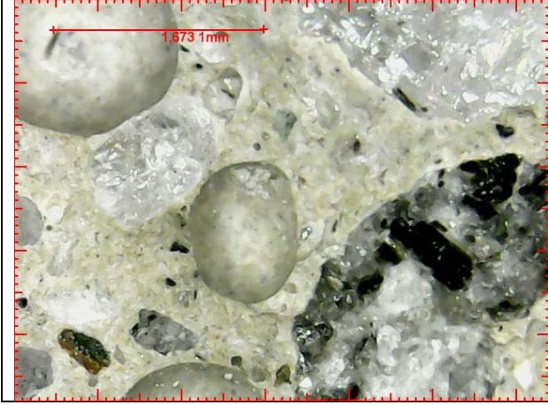
Ampliación de Mezcla de concreto y mineral de metacaolín.
