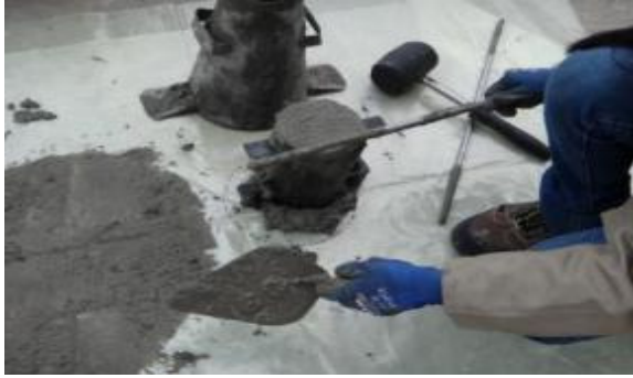
Fotografía 3. Elaboración y encofrado de los especímenes cilíndricos para la prueba. Fuente. Elaboración propia, durante el proceso la producción de los cilindros de concreto.
