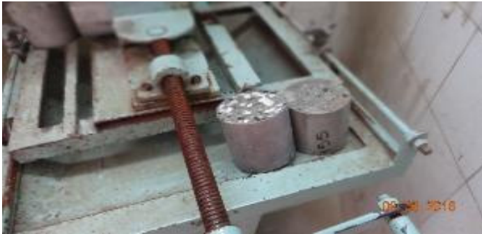
Fotografía 8. Actividad de acerrado de la muestras en las dimensiones requeridas. Fuente: Elaboración propia, proceso de corte de las muestras, laboratorios ASOCRETO.
