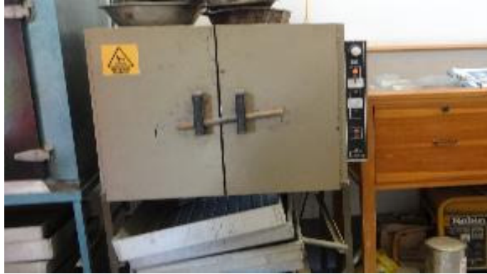
Fotografía 13. Horno para el calentamiento de las muestras en temperaturas entre 100 a 110°C Fuente: Elaboracion propia, laboratorio de suelos y rocas ECI.
