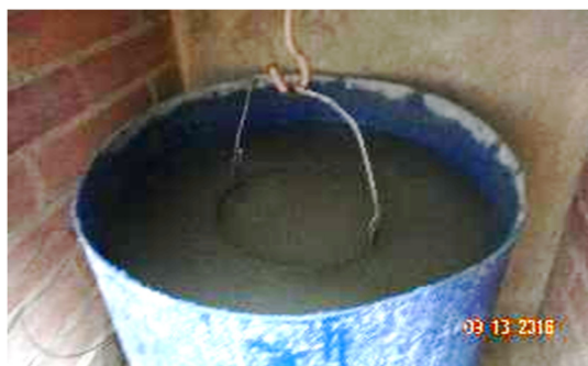
Fotografía 16. Recipiente metálico, proceso de cocción y saturación de especímenes con agua hervida Fuente: Elaboracion propia, laboratorio ASOCRETO.
