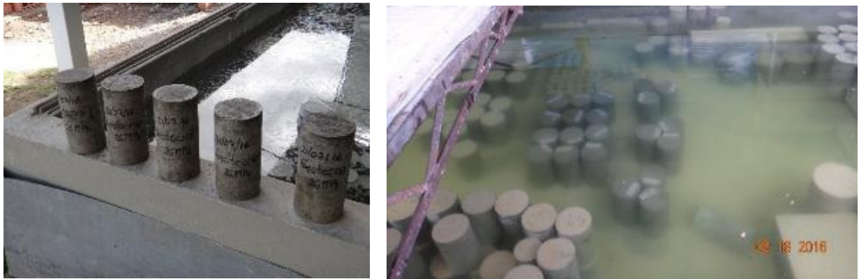
Fotografía 4. Especímenes sumergidos durante 28 días en las instalaciones de la Escuela. Fuente. Elaboración propia, proceso curado de los especímenes, piscina ECI.
