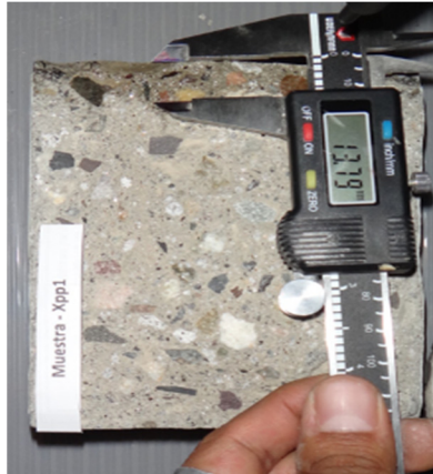
Figura 135. Medición de la infiltración de agua en el Concreto. Fuente: El autor.
