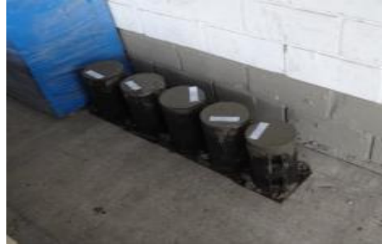
Fotografía 3. Elaboración y encofrado de los especímenes cilíndricos para la prueba. Fuente. Elaboración propia, durante el proceso la producción de los cilindros de concreto.
