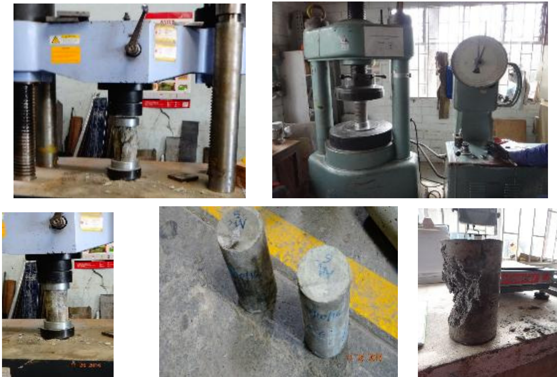
Fotografía 5. Prueba de resistencia en los cilindros elaborados. Fuente. Elaboración propia, durante el proceso evaluación de resistencia en los especímenes.
