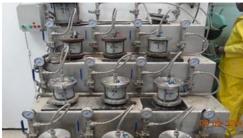
Fotografía 10. Montaje de los especímenes en los equipos para la presión hidráulica. Fuente: Elaboración propia, celdas medición de permeabilidad laboratorio ASOCRETO.
