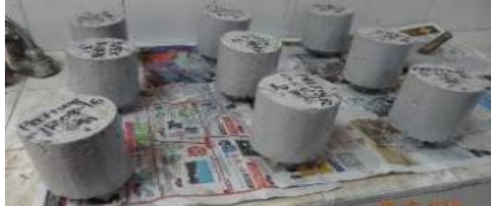
Fotografía 7. Recubrimiento con pintura epoxica en la parte lateral de los cilindros. Fuente: Elaboración propia, proceso de impregnación epoxica lateral de las muestras.
