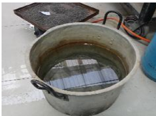
Fotografía 15. Recipiente metálico, proceso de cocción y saturación de especímenes con agua hervida Fuente: Elaboracion propia, laboratorio ASOCRETO.
