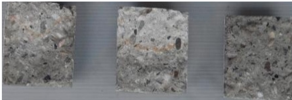
Fotografía 12. Infiltración del agua en algunos especímenes de concreto sin aditivos y pre fisurado Fuente: Elaboración propia, toma de datos infiltración de agua en los especímenes de concreto.
