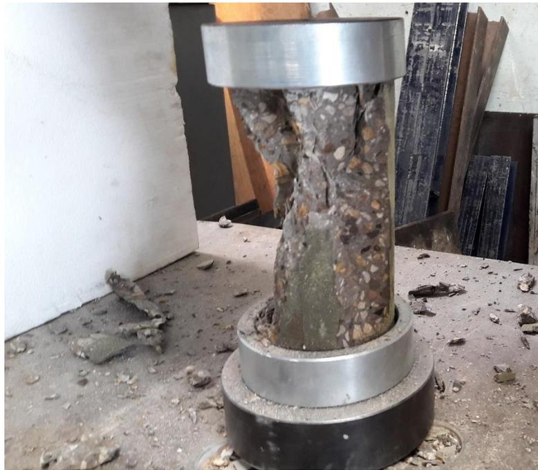
*Figura 48. Cilindro de concreto ensayado a compresión a los 28 días.
