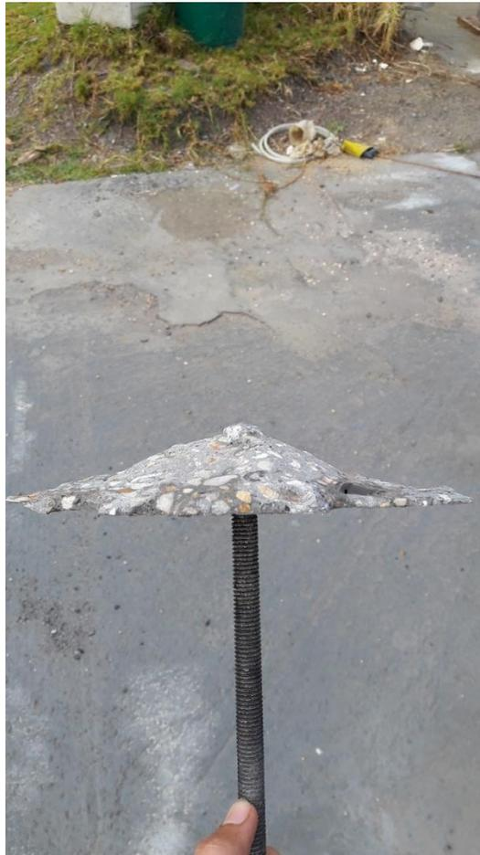
*Figura 42. Falla por arrancamiento del concreto con extracción de anclaje  $\phi 1/2''$  a profundidad de embebido de 5 veces el diámetro.
