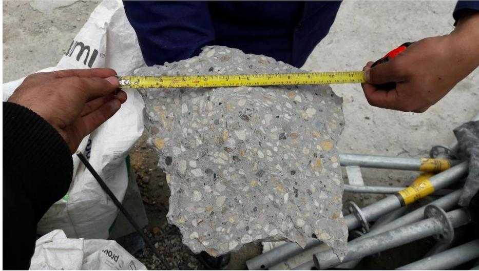
*Figura 43. Falla por arrancamiento del concreto con extracción de anclaje  $\phi 5/8$ " a profundidad de embebido de 5 veces el diámetro.
