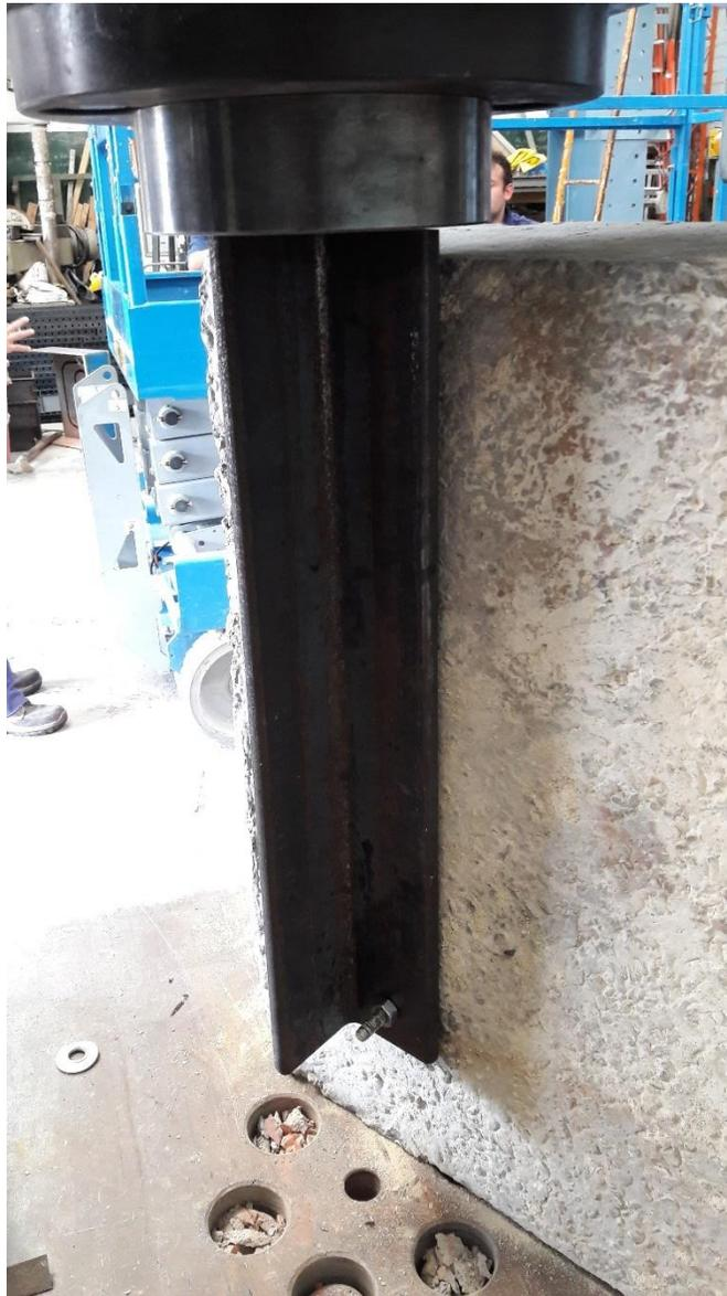
*Figura 19. Montaje final para ensayos a cortante.*
