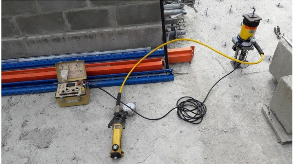
Figura 17. Consola de medición, bomba hidráulico y montaje para ensayos no confinados a tensión.
