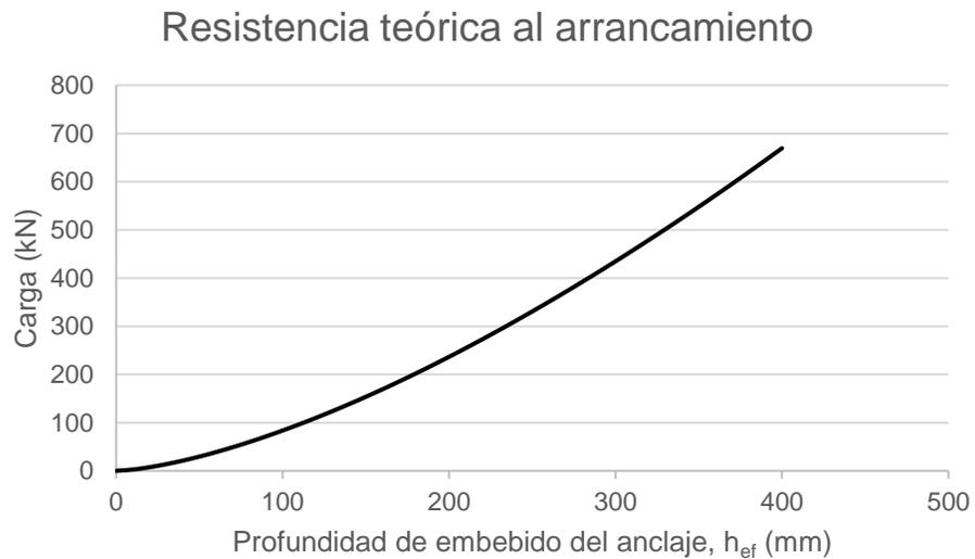
Figura 22. Resistencia teórica al arrancamiento.
