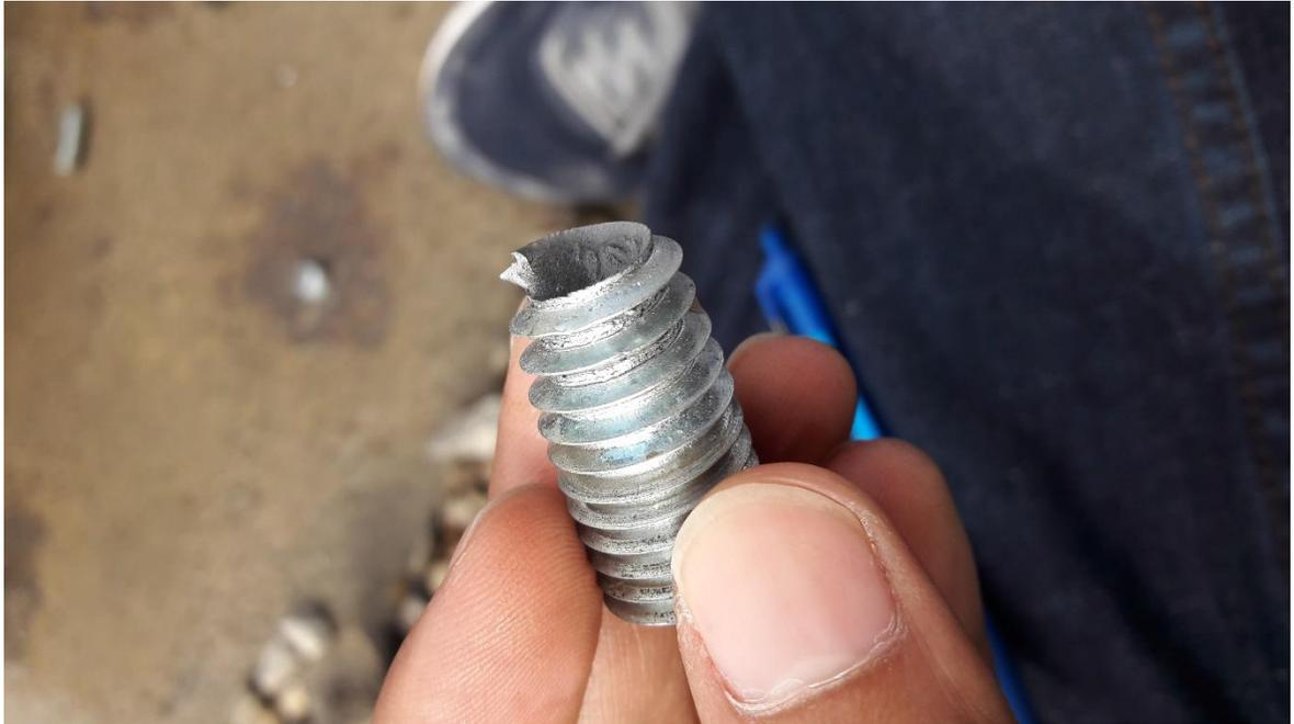
*Figura 32. Anclaje  $\phi 1/2''$  después de ensayo confinado a tensión. Falla del acero.*
