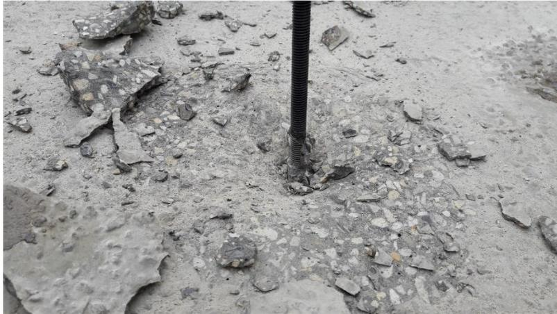
*Figura 41. Falla por arrancamiento del concreto sin extracción de anclaje  $\phi 1/2''$  a profundidad de embebido 2.5 veces el diámetro.
