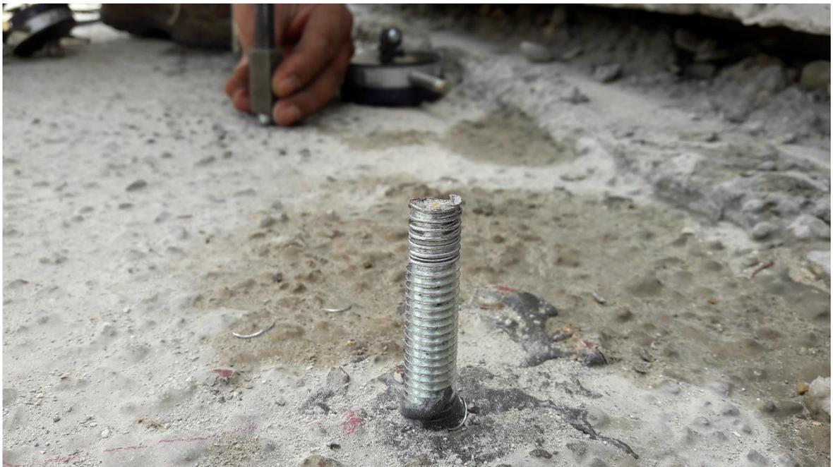
*Figura 31. Anclaje  $\phi 3/8$ " después de ensayo confinado a tensión. Falla del acero.
