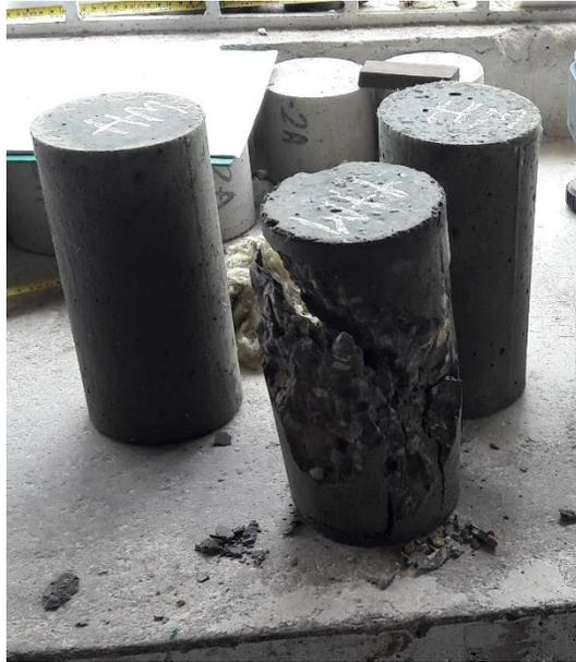
*Figura 47. Cilindro de concreto ensayado a compresión a los 14 días.
