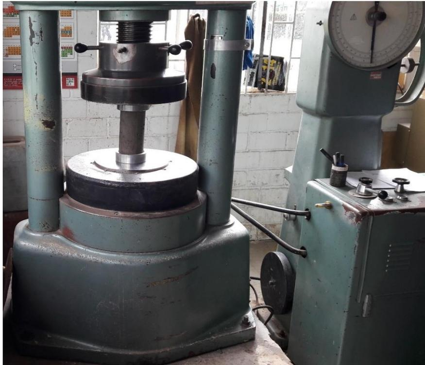
*Figura 46. Cilindro de concreto en máquina de ensayo.*
