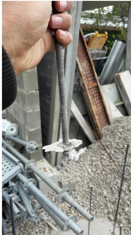
*Figura 40. Falla por adherencia de anclaje  $\phi 3/8$ " a profundidad de embebido igual a 2.5 veces el diámetro.
