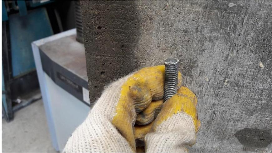
*Figura 35. Anclaje  $\phi 1/2$ " después de ensayo a corte. Falla del acero.
