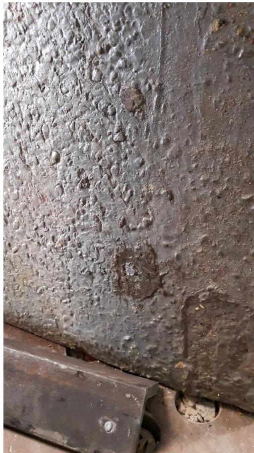
*Figura 36. Superficie de la losa ensayada. Corte total del anclaje.
