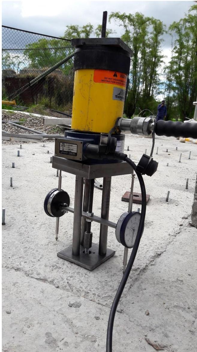
*Figura 16. Montaje final para ensayos confinados a tensión.
