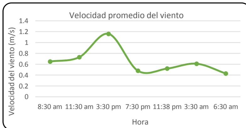
En la figura 2-8 se muestra el comportamiento de la velocidad del viento en la planta de tratamiento. La velocidad promedio es de 0,65 m/s, variando considerablemente durante el día, con velocidad máxima de 2,0 m/s en horas posteriores al mediodía y mínima, entre 0,1-0,2 m/s, en horas de la noche.
