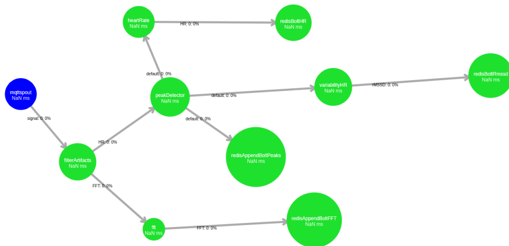
FIGURA 4.3: Implementación concreta de la topología mostrada en Fig. 4.2 con Apache Storm
