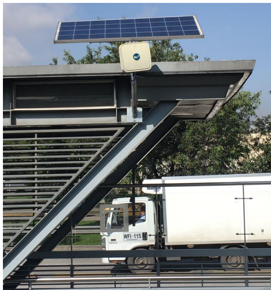
Figura 36 Sensor wifi-bluetooth Troncales Fuente: El autor adaptado de la SDM
