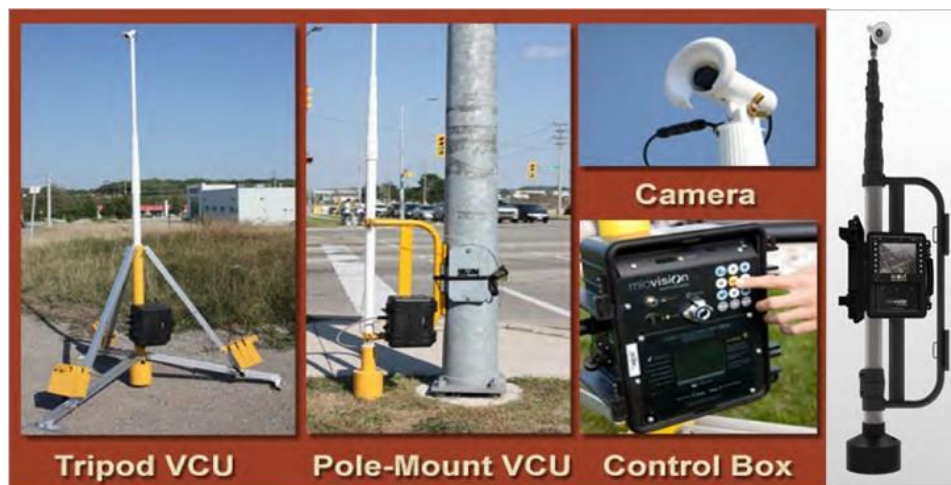
Figura 77 Sistemas cámaras de video detección Scout. Fuente: Miovision Counting Equipment (INDOT, s.f.)
