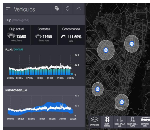
Figura 38 Ubicación sensores de conteo vehicular Fuente: Información oficial SDM Centro de Gestión
