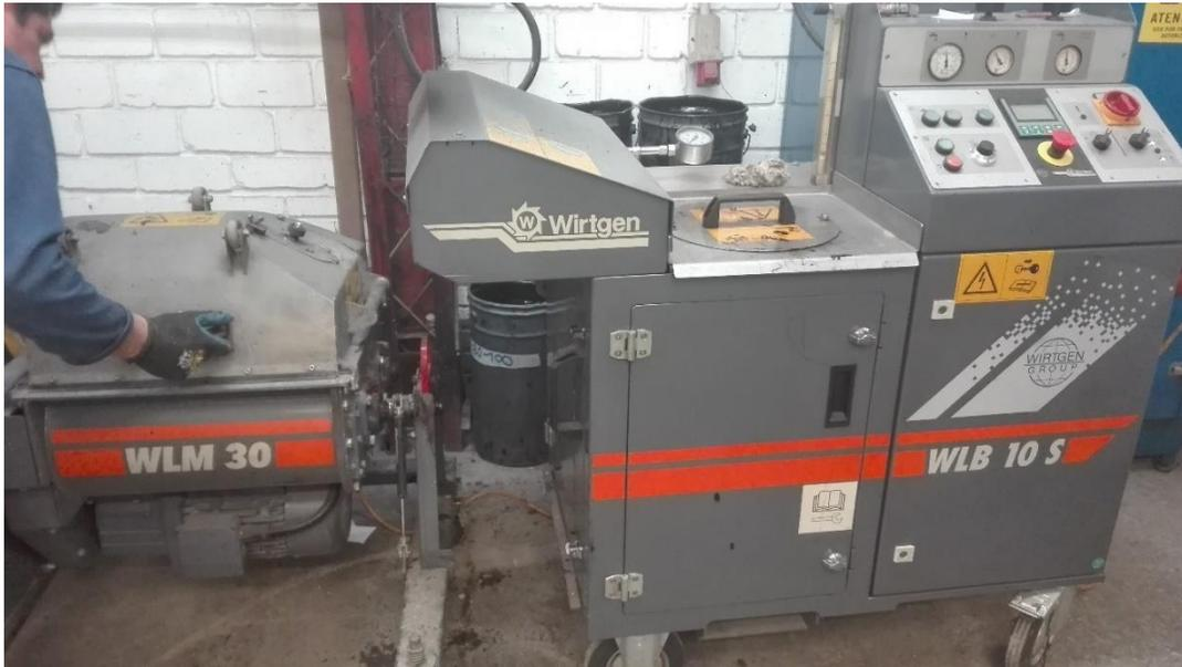
Para la caracterización de la espuma de asfalto se realizaron variaciones de las temperaturas del asfalto entre 140°C y 170°C y en las concentraciones de agua desde 2.0% con incrementos de 0.5% hasta alcanzar el 4.0%. Una vez realizadas las pruebas de espumado a cada uno de los asfaltos se determinaron las temperaturas y el porcentaje óptimo de agua para garantizar los parámetros de vida media y relación de expansión como se muestra a continuación.
