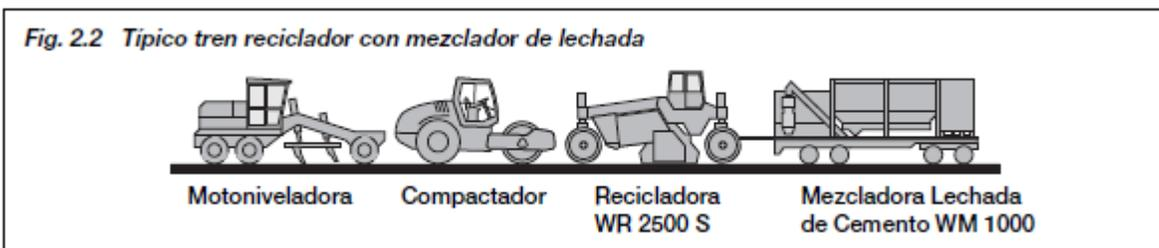
**Figura 11 Típico tren reciclador con mezclador de lechada, Manual de Reciclado en Frio (Wirtgen, 2012).**
