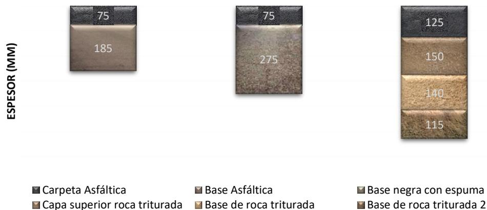
**Figura 1 Equivalencias de espesores (Bowering, 1970)**
