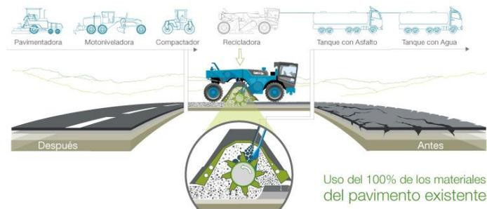
**Figura 9 Funcionamiento de la recicladora de pavimento (Wirtgen, 2012)**
