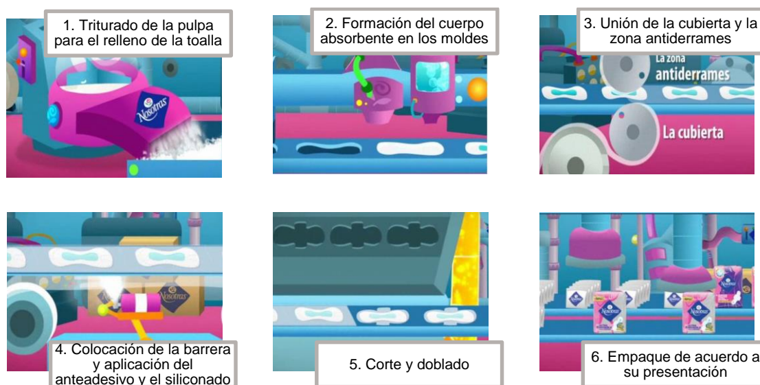
Figura 2.2 Proceso de producción de una toalla higiénica.
