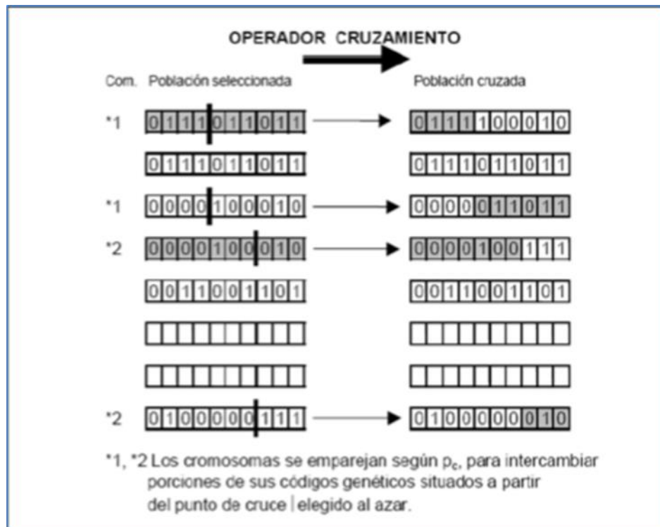
Imagen 14 Operador de cruzamiento AG. Fuente: Agustín Matías Sánchez (2003); Diseño de redes de distribución de agua contemplando la fiabilidad, mediante Algoritmos Genéticos, Tesis Doctoral, Universidad Politécnica de Valencia. Pág.133
