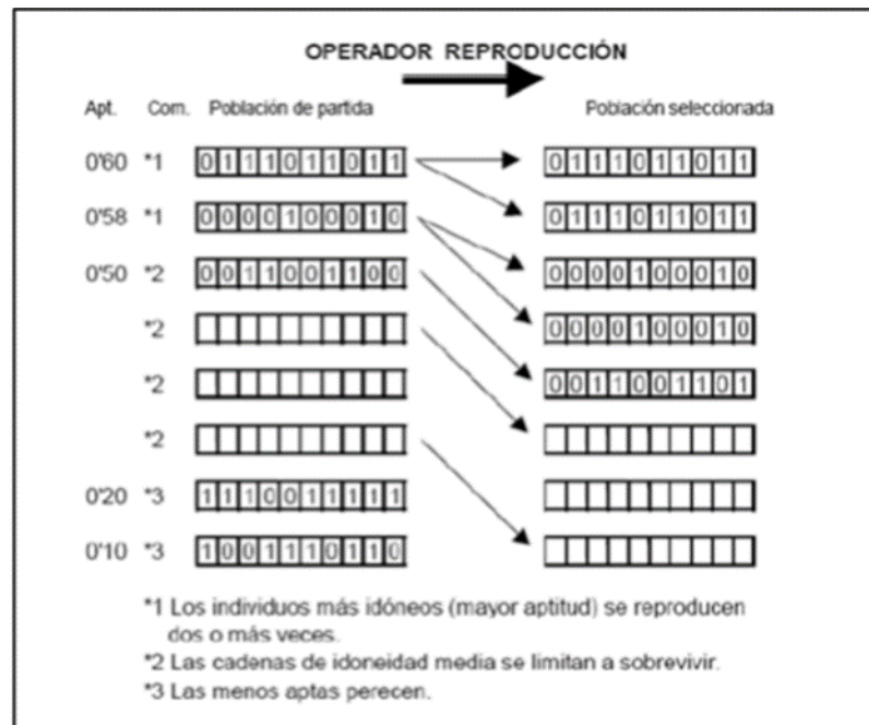
Imagen 13 Operador de Reproducción A.G. Fuente: Agustín Matías Sánchez (2003); Diseño de redes de distribución de agua contemplando la fiabilidad, mediante Algoritmos Genéticos, Tesis Doctoral, Universidad Politécnica de Valencia. Pág.132
