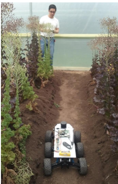
Figura 22. Movimiento del vehículo a través de los surcos del invernadero controlado por el joystick. Fuente autor, 2018.
