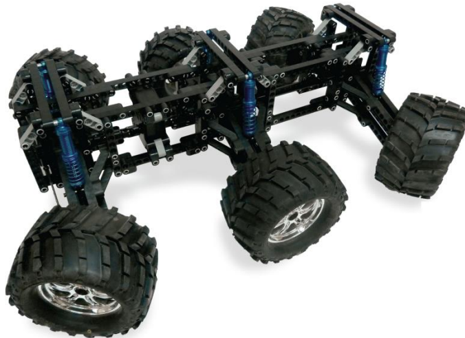
Figura 9. Robot Rover de 6x6. Recuperada de: Minds-i (2018)
