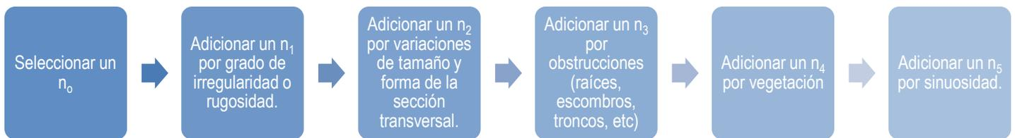
**Figura 9.** Pasos para selección del coeficiente de Manning según Cowan.
