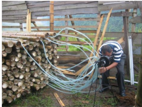
Secado de guaduas con inyección de aire
