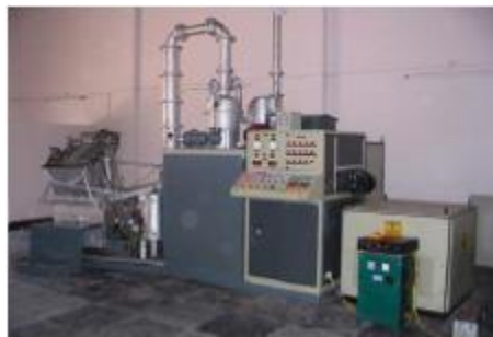
Figura 13. Reactor de pirólisis de plasma instalado en el Colegio Médico de Goa en 2004. Fuente: Institute for plasma research. India.
