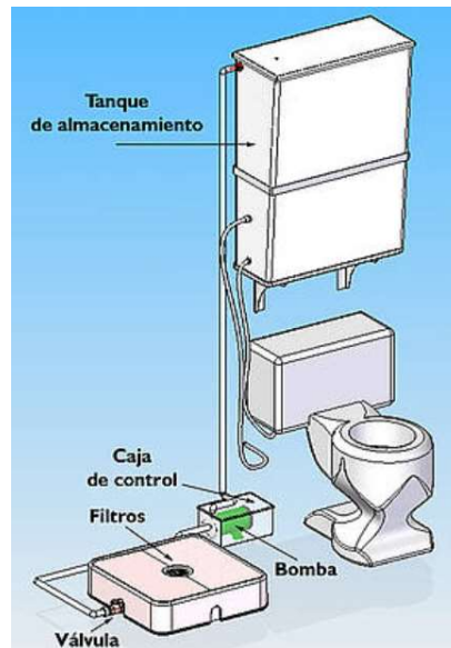
Ilustración 9-2. Sistemas Hidráulicos con reúso del agua (Aponte, 2016)
