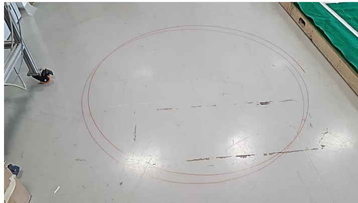
Fig. 34. Ejemplo de los desplazamientos presentados por el robot al moverse en círculos.
