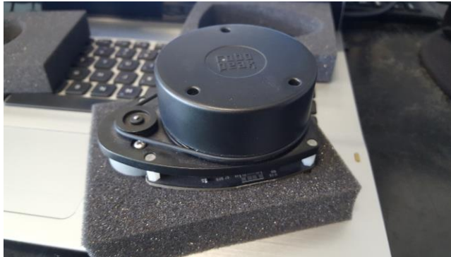
Fig. 13. RPLIDAR A1 radar óptico láser usado en el robot.
