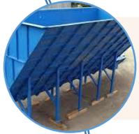
**Mezclado: 3 tolvas metálicas de 30 tn capacidad y 1 Cargador de piso con pala de capacidad de 3 metros cúbicos**
