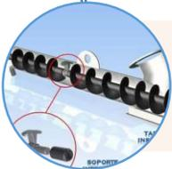
**Homogenizado: 1 homogeneizador de tornillo capacidad 35 tn/hora**
