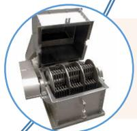
**Pulverización: 1 molino de martillos con apertura de rejilla de 0,3mm**
