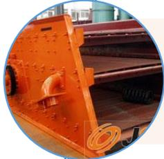
**•Estabilización: 1 Criba metálica de 2 secciones de 3 x 7 metros de sección con capacidad 30 ton/hora y mallas en acero inoxidable**
