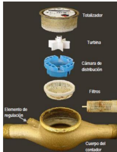
Ilustración 9.8 Medidor de chorro múltiple
