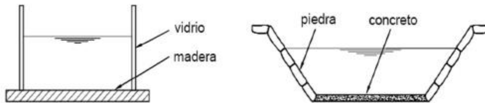
Figura 15. Ejemplos característicos de rugosidad compuesta.
