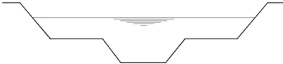
Figura 12. Sección compuesta canal artificial
