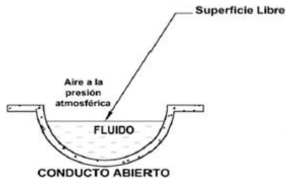
Figura 3. Flujo en conducto abierto (canales)
