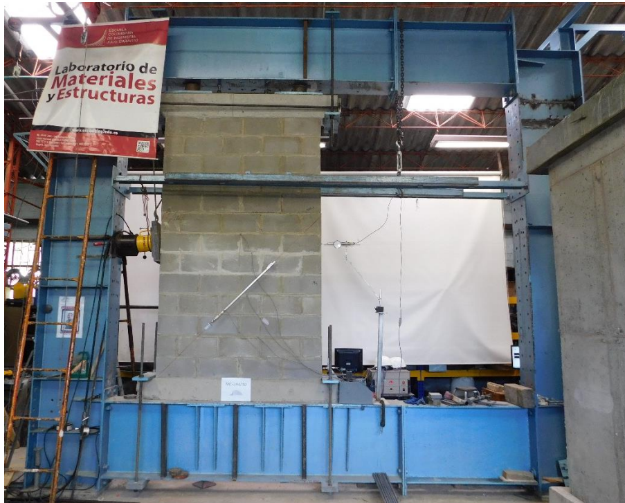
Fotografía 4.27 Montaje para los ensayos a corte directo
