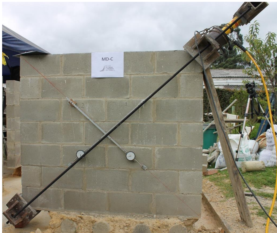
Fotografía 4.26 Montaje para los ensayos a compresión diagonal
