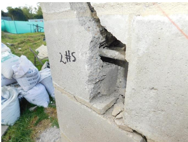
Fotografía 5.39 Falta de confinamiento de las barras de GFRP en la primera celda de la hilada 5
