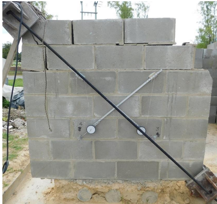
Fotografía 5.18 Fisuras en la cara posterior del muro MD-1#5/60
