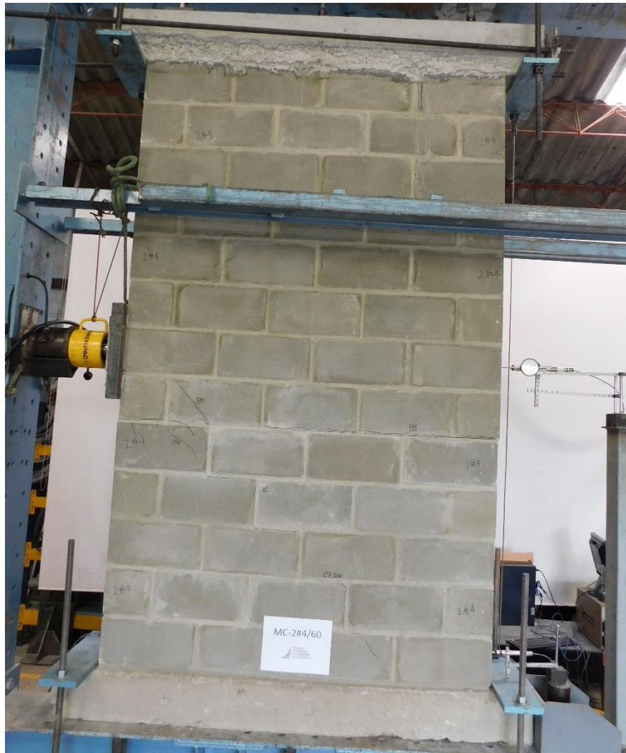
Fotografía 5.65 Fisuras en la cara frontal del muro MC-2#4/60
