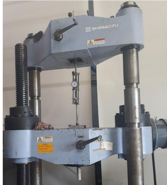
Fotografía 4.3 Montaje del ensayo de resistencia a la tensión en barras de GFRP
