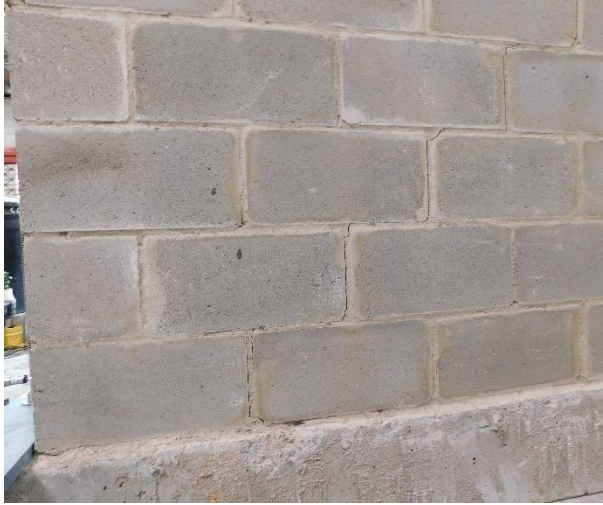
Fotografía 5.44 Fisuras de la parte inferior izquierda en la cara posterior
