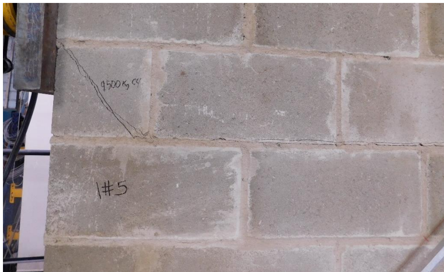
Fotografía 5.59 Línea de falla entre las hiladas 5 y 6 de parte izquierda en la cara frontal
