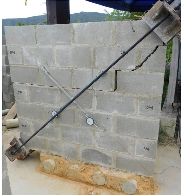
Fotografía 5.29 Fisuras en la cara posterior del muro MD-2#4/40
