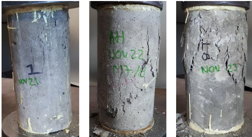
Fotografía 5.4 Modos de falla de los cilindros de mortero de relleno en el ensayo de resistencia a la compresión para los muros de corte directo
