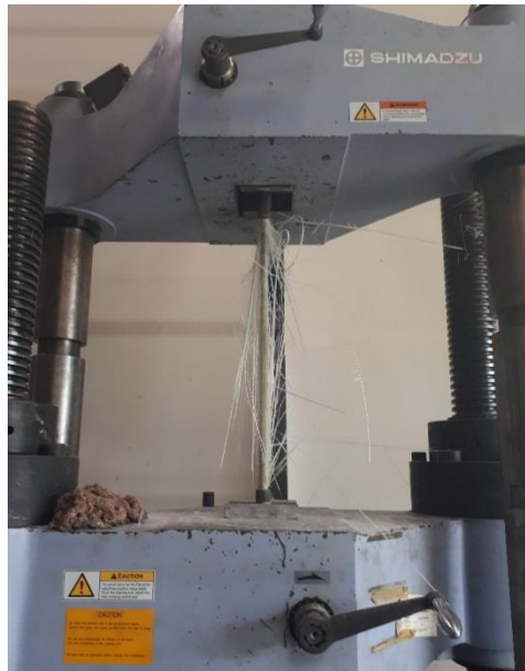
Fotografía 5.5 Ensayo de resistencia a la tensión en barras de GFRP
