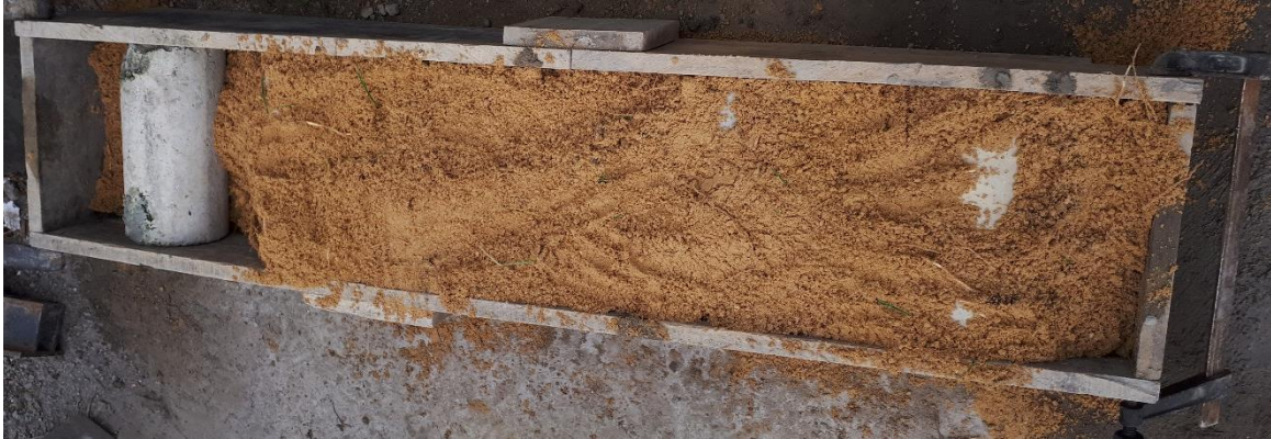
Fotografía 4.4 Armado de la cama de arena con cilindros de concreto
