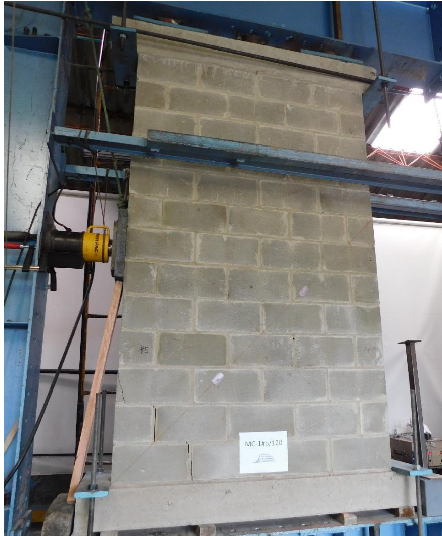
Fotografía 5.49 Fisuras en la cara frontal del muro MC-1#5/120
