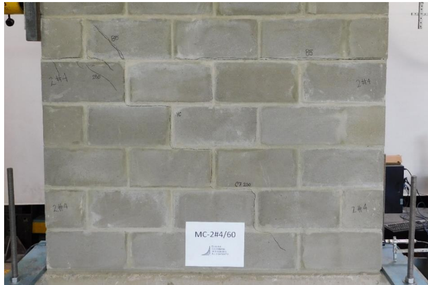
Fotografía 5.66 Fisuras de la parte inferior en la cara frontal
