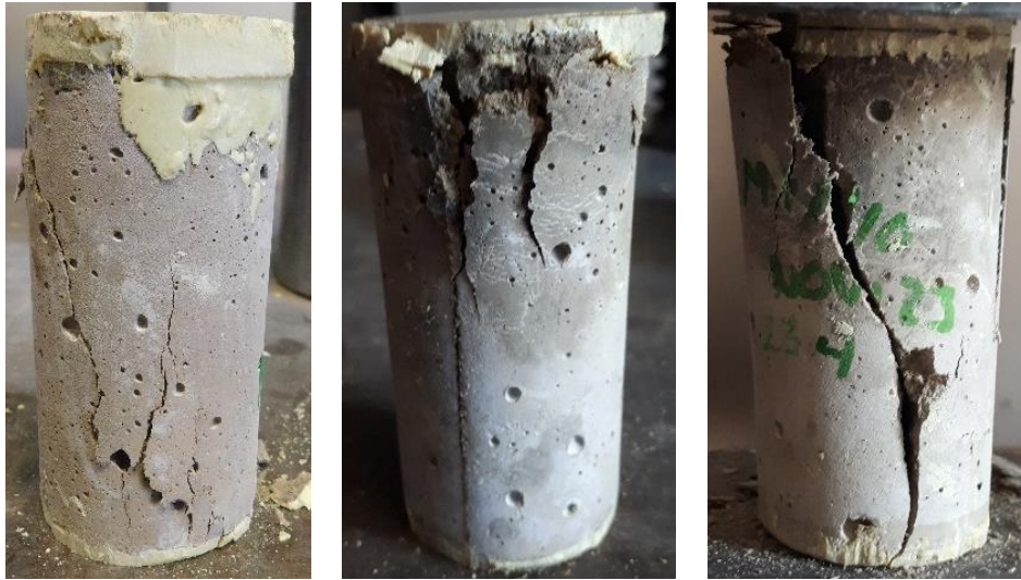
Fotografía 5.2 Modos de falla de los cilindros de mortero de pega en el ensayo de resistencia a la compresión para los muros de corte directo
