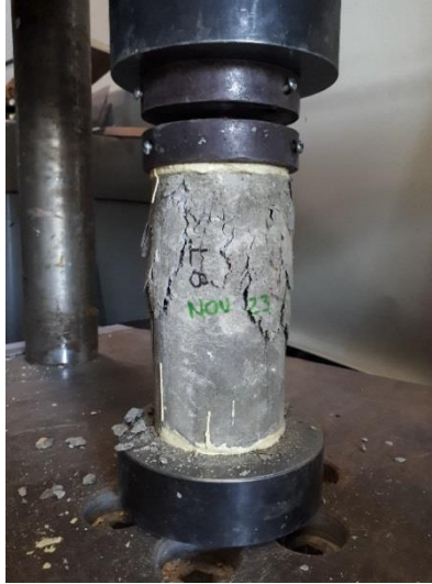
Fotografía 5.3 Ensayo de resistencia a la compresión de un cilindro de mortero de relleno
