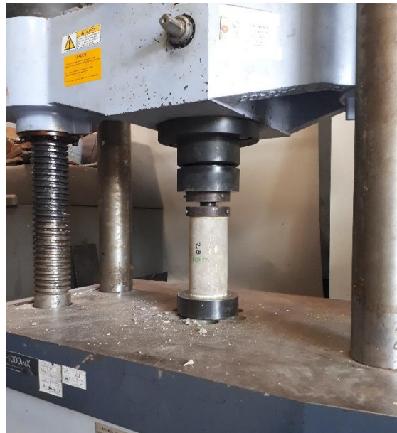
Fotografía 4.2 Montaje del ensayo de resistencia a la compresión en cilindros de mortero de relleno
