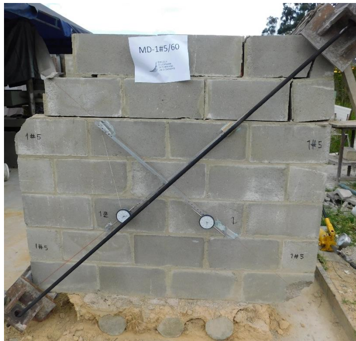
Fotografía 5.17 Fisuras en la cara frontal del muro MD-1#5/60
