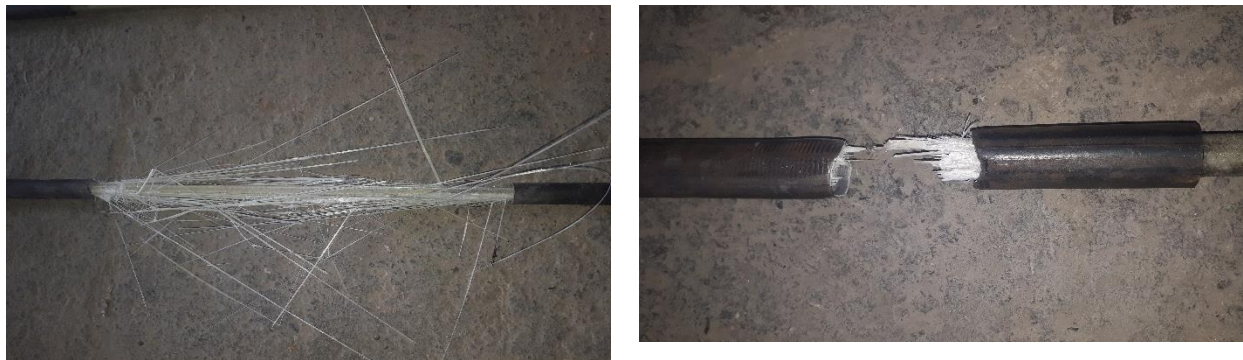
Fotografía 5.6 Modos de falla de las barras de GFRP en el ensayo de resistencia a la tensión
