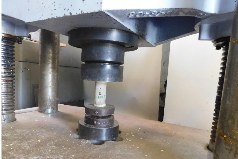
Fotografía 4.1 Montaje del ensayo de resistencia a la compresión en cilindros de mortero de pega
