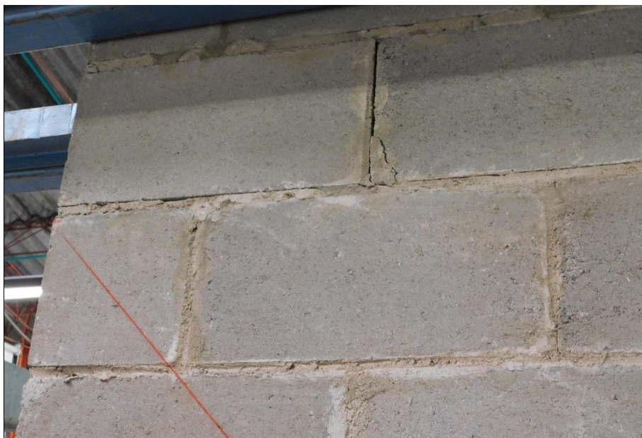
Fotografía 5.79 Línea de falla entre las hiladas 8, 9 y 10 de parte izquierda en la cara posterior
