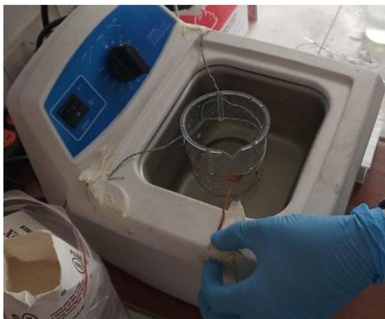
**Figura 20:** Ultrasonido. Foto tomada durante el proceso de limpieza de sustratos (vidrio).
