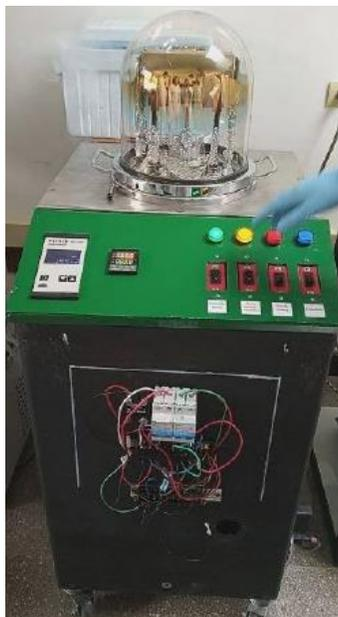
**Figura 22:** Máquina de evaporación de oro. *Foto tomada durante el proceso de deposición de oro sobre el sustrato vidrio.*
