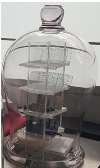
**Figura 21:** Cámara de vacío para almacenar sustratos limpios. *Foto tomada durante el proceso de limpieza de sustratos (vidrio).*
