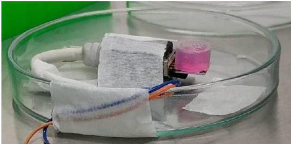
**Figura 26:** Montaje de electrodo IDA para toma de datos en tiempo real. *Foto tomada durante el proceso de montaje del experimento de medición de capacitancia en tiempo real.*
