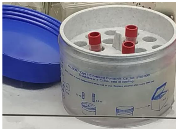
Figura 12. Cooler donde se conservan las células en nevera de -80^{\circ}\text{C} . Congelamiento de células M8.
