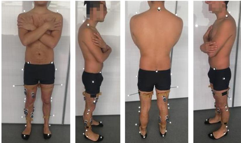
Fig. 17: Disposición final de electrodos, sensores de electromiografía y marcadores reflectivos.
