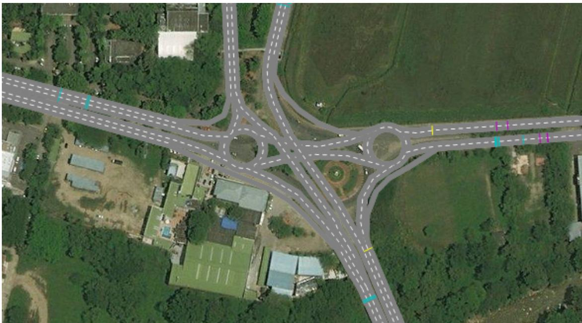
Figura 5-2 Intercambiador – Red de simulación Fuente: Elaboración propia utilizando PTV Vissim
