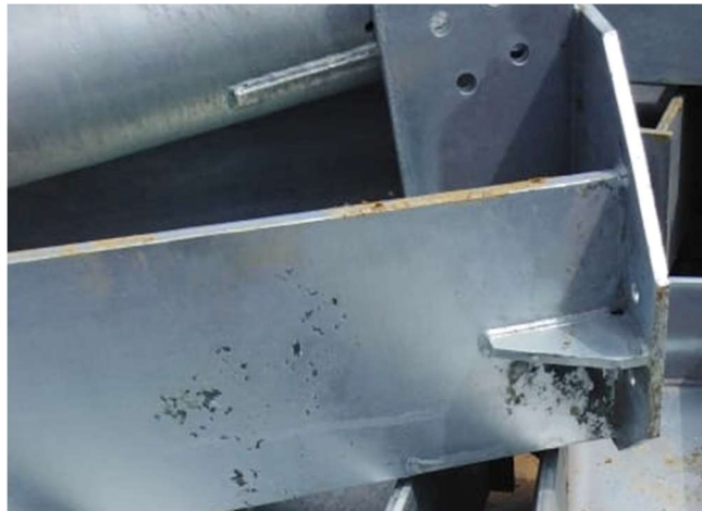
Figura 170. Oxido y desprendimientos del acabado (archivo propio)
