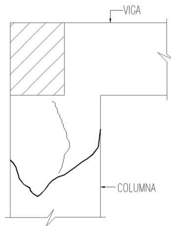
Figura 101. Agrietamiento en cabeza de columna segundo piso (archivo propio)
