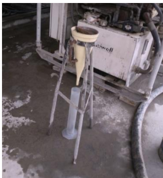
Fotografía 5.1. Cono de Marsh preparado para iniciar el ensayo de viscosidad. Fuente del autor.
