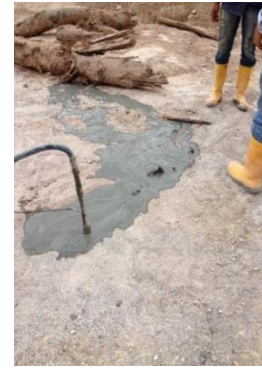
Fotografía 11.2. Pruebas de campo para estimar la presión máxima cerca a la superficie. Fuente del autor.
