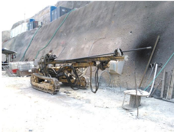
Fotografía 8.2. Perforadora de rotopercusión.
