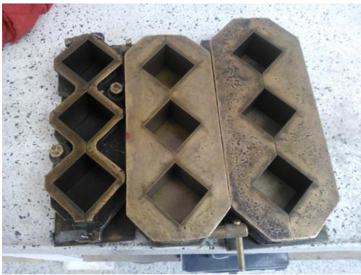
Fotografía 5.1. Formaleta utilizada para los cubos de mezcla. Fuente del autor.
