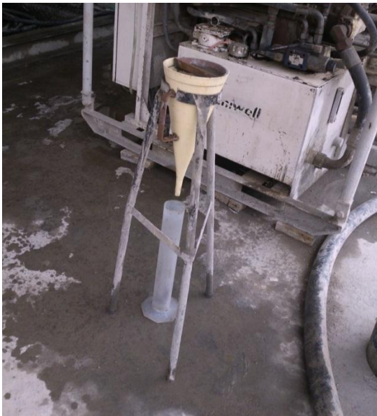
Fotografía 5.4. Cono de Marsh preparado para iniciar el ensayo de viscosidad. Fuente del autor.
