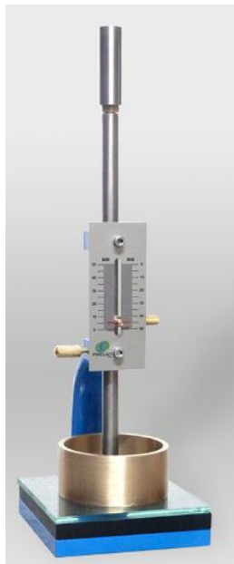
Figura 5.4. Aguja de Vicat Tomado de Pinzuar (2019a).
