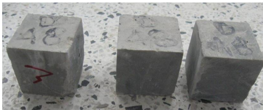
Fotografía 5.3. Cubos de 5 x 5 cm de mezcla utilizada, verificándolos para realizar el ensayo de resistencia a la compresión en laboratorio. Fuente del autor.
