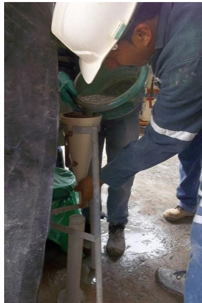
Fotografía 5.5. Ejecución del ensayo vertiendo la mezcla utilizada para la inyección en el cono. Fuente del autor.
