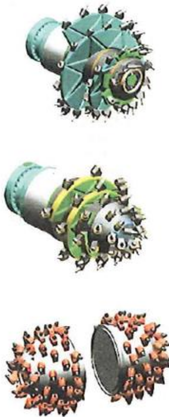
Ilustración 5 – 96: Esquema de una rozadora de superficie. (Carlos López Jimeno et al., 2012)
