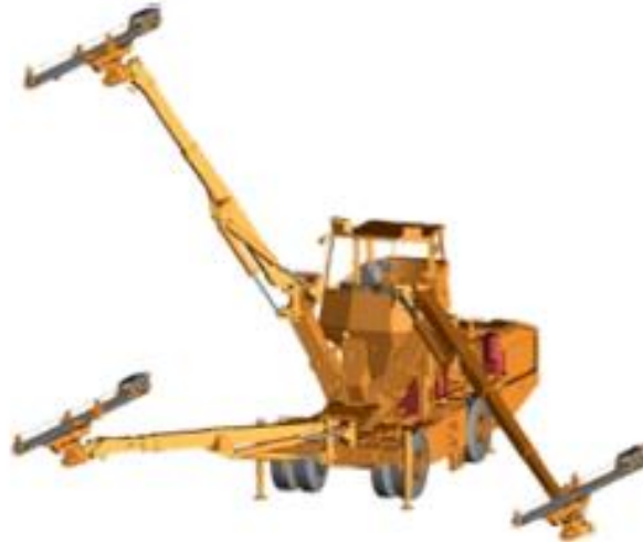
Ilustración 5 - 40: Esquema típico de un jumbo. (Iñigo Escobal, 2015)
