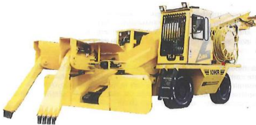
Ilustración 5 – 50: Esquema de la cargadora con brazos recolectores. (C. López Jimeno et al., 2013)
