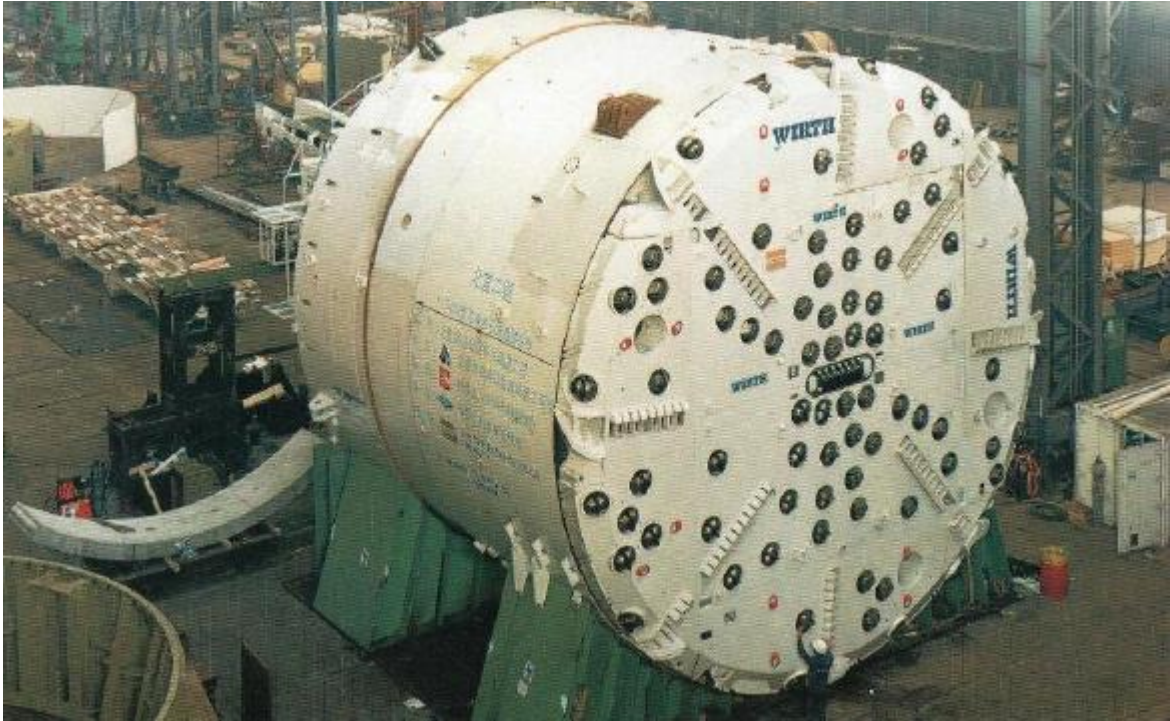
Ilustración 3 - 43: Fotografía de una TBM de doble escudo de la fábrica Wirth en Pinglin-Taiwan. (Giraldo, 2010).
