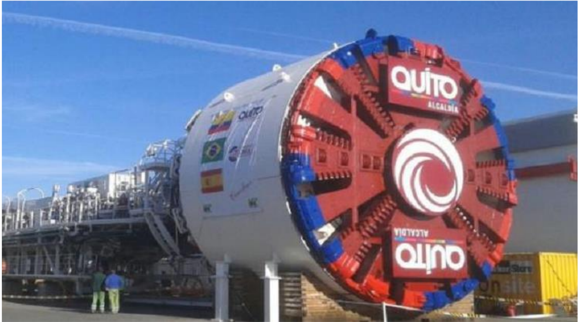
Ilustración 2 - 3: Sistema de perforación con TBM. ( www.ubicatv.com/ecuador ).
