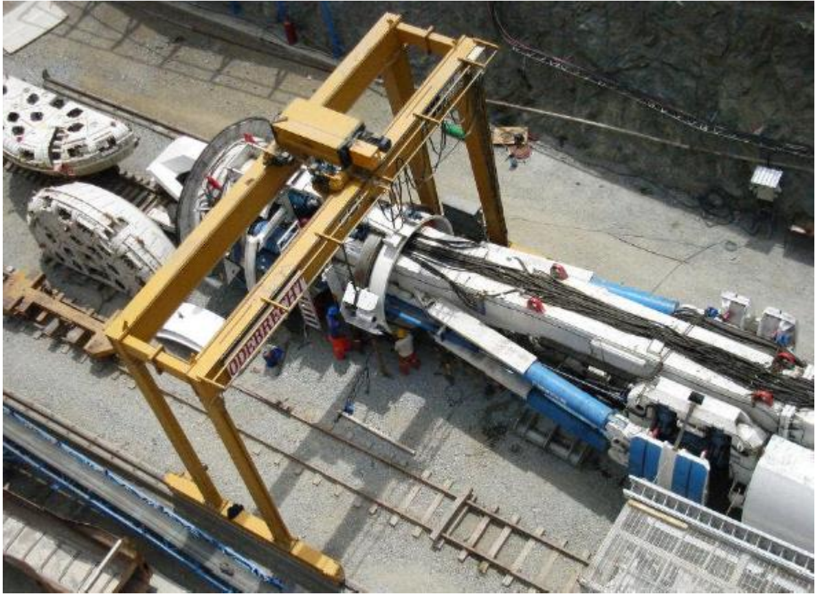
Ilustración 3 - 42: Fotografía de una TBM de viga principal “MB 200” de la fábrica Robbins en Lambayeque. (Giraldo, 2010).
