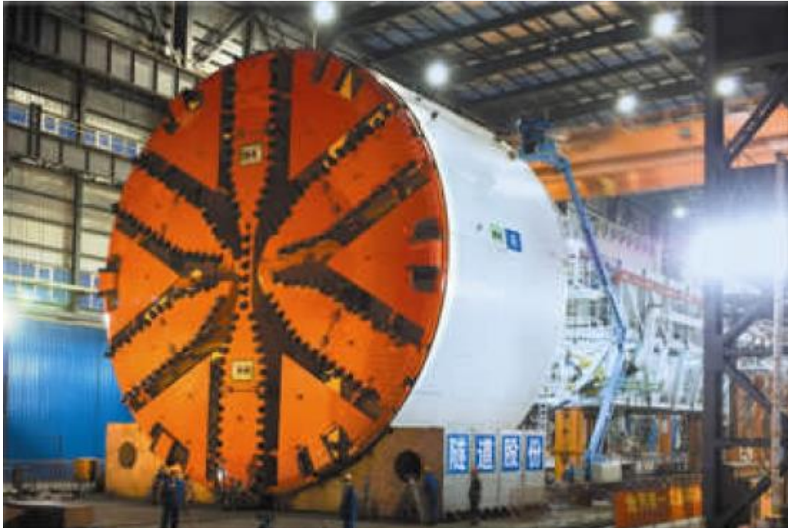
Ilustración 3 - 44: Fotografía de una TBM de simple escudo de la fábrica Herrenknecht de 15.43 m de diámetro en Shanghai. (Giraldo, 2010).
