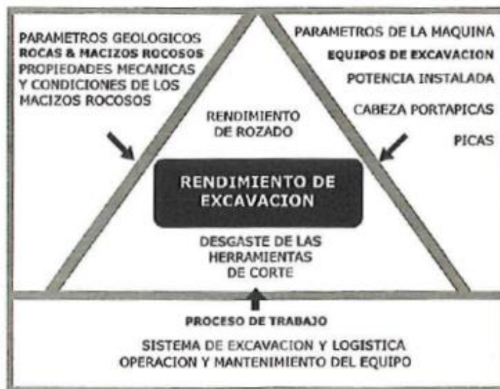
Ilustración 5 – 105: Principales parámetros que influyen en el rendimiento de la excavación con rozadoras. (Carlos López Jimeno et al., 2012)
