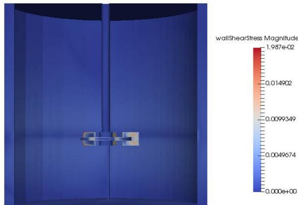
*Figura 41 Esfuerzos cortantes ( $m^2/s^2$ ) en el tanque con un corte vertical en el modelo de turbulencia  $k - \varepsilon$  estándar.*
