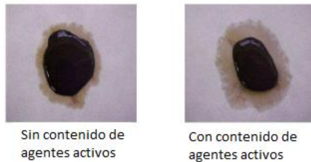
Figura 41. Naturaleza hidrofóbica de la superficie debido a la adición de un agente activo (cal o cemento). Fuente: Adaptado de (Mathaniya Twagira, 2010)
