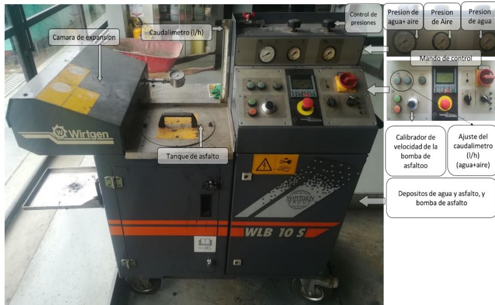
Figura 79. Planta de FA WLB 10s Wirtgen. Fuente: Elaboración del autor.
