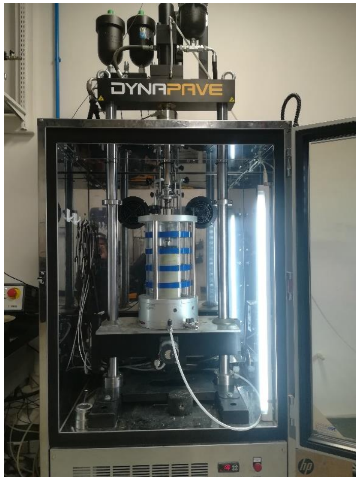
Figura 96. Equipo triaxial dinámico DYNAPAVE. Fuente: Elaboración del autor.
