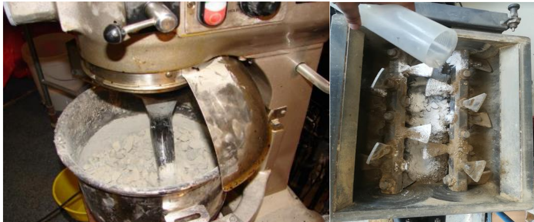
Figura 53 Mezcladoras de las plantas WLB 10 y WLB 10S. Fuente: Elaboración del autor.
