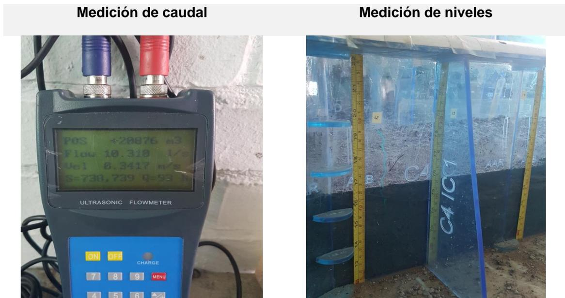
Ilustración 4-4. Instrumentos de medida de caudal y niveles de lecho y lámina de agua.
