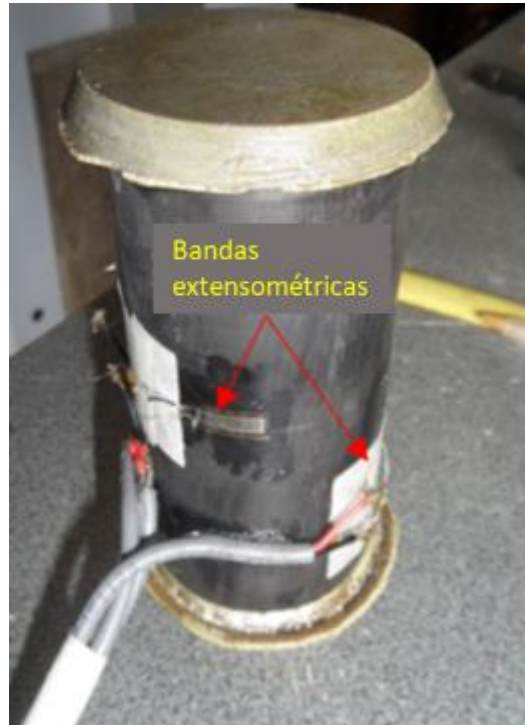
Foto 4. Probeta preparada para el ensayo de compresión simple, con bandas extensométricas para la medida de deformaciones axial y transversal o radial.
