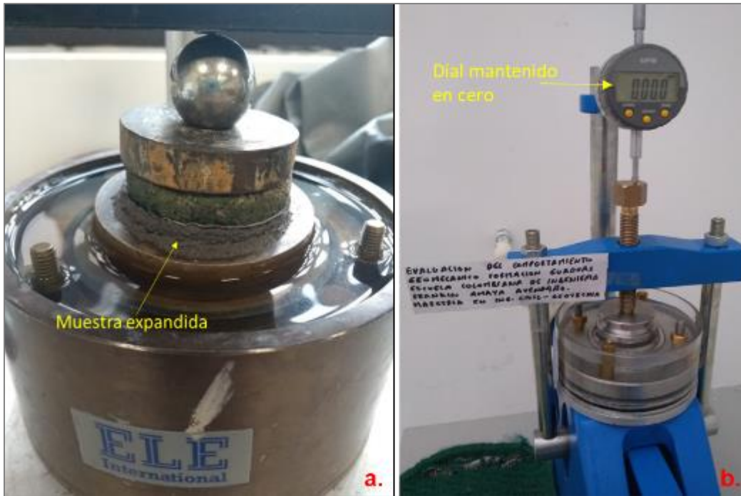
Foto 21. Ensayos de expansión.
