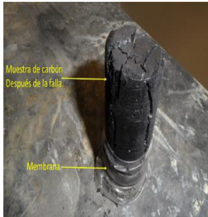
Foto 6. Rotura de probeta en carbón- ensayo de compresión triaxial.
