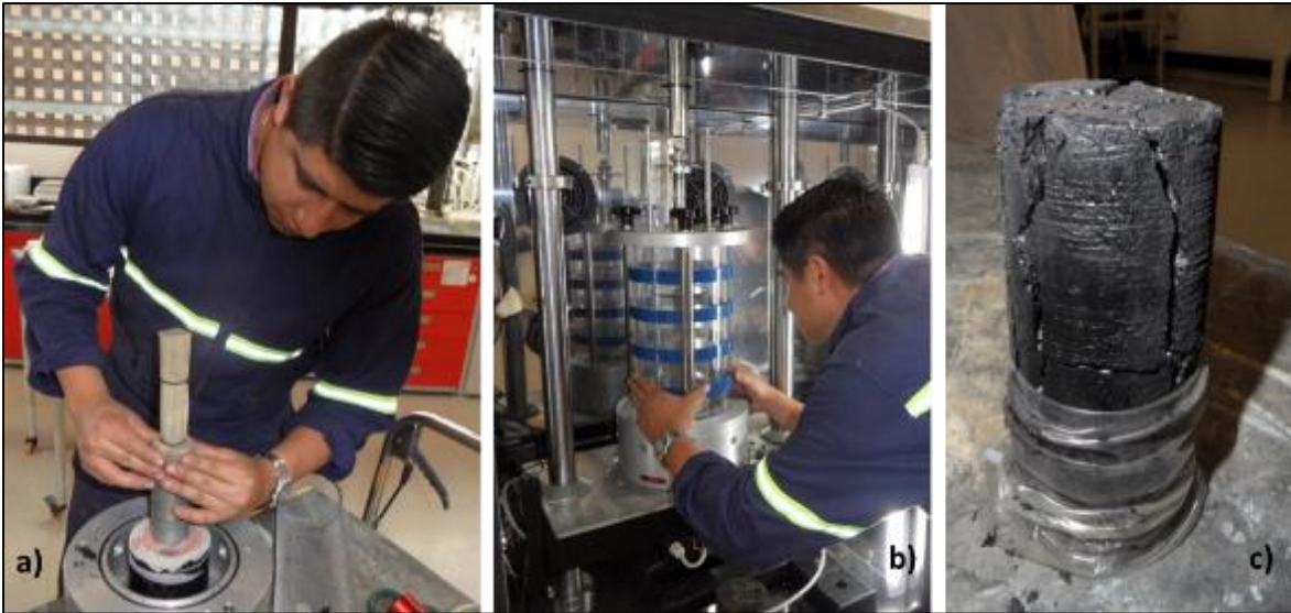
Foto 20. Proceso para realización de ensayo triaxial en probetas de carbón.
