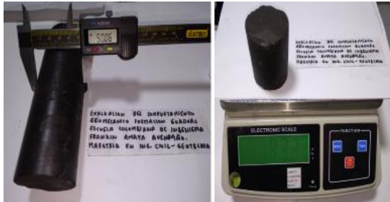
Foto 17. Toma de datos (dimensiones geométricas y pesos) en probetas cilíndricas de roca.
