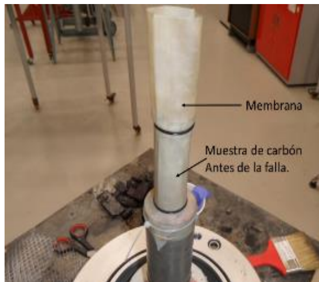
Foto 5. Probeta preparada para el ensayo de compresión triaxial, Obsérvese la membrana impermeable. Fuente: Propia
