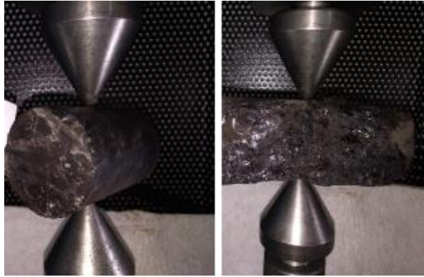
Foto 18. Pruebas de carga puntual en muestras cilíndricas e irregulares.
