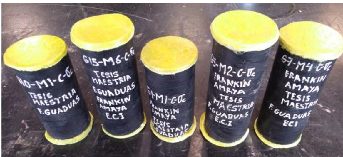
Foto 13. Refrentado de caras usando azufre para las muestras de roca ensayadas a compresión uniaxial.
