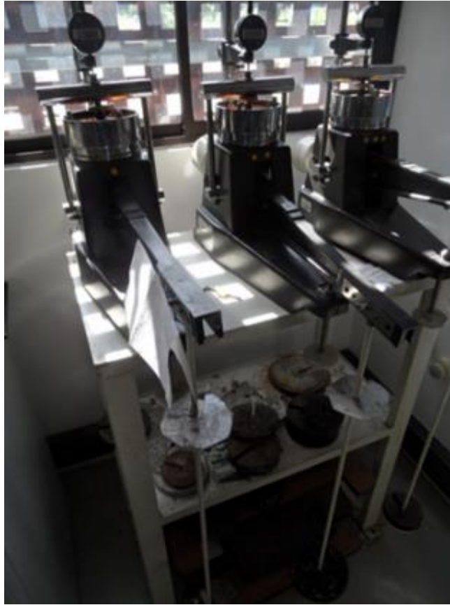
Foto 8. Consolidómetro usado para el ensayo de expansión controlada.
