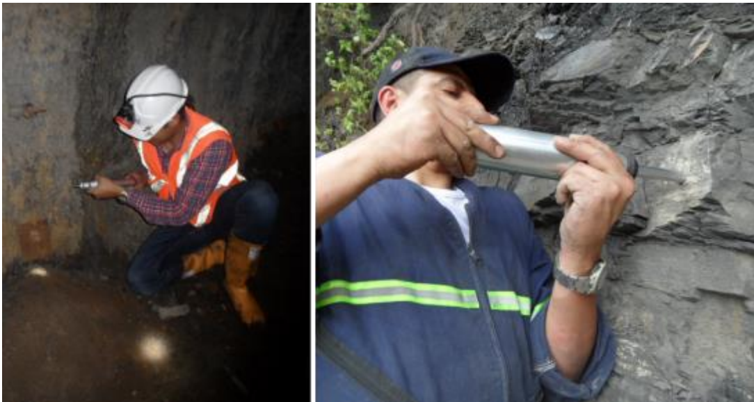
Foto 12. Toma de lecturas con Martillo Schmidt sobre afloramientos de carbón y materiales de respaldo tanto en superficie como en labores subterráneas de explotación.
