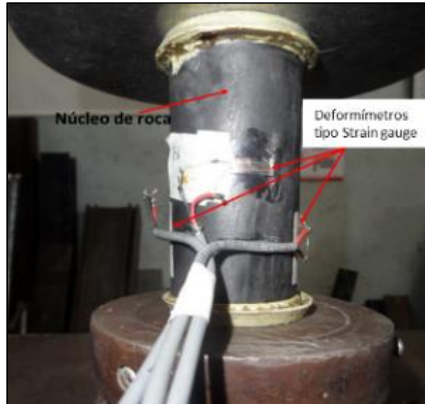
Foto 14. Instalación de Strain Gauge para medición de deformaciones durante la prueba de resistencia a la compresión uniaxial.
