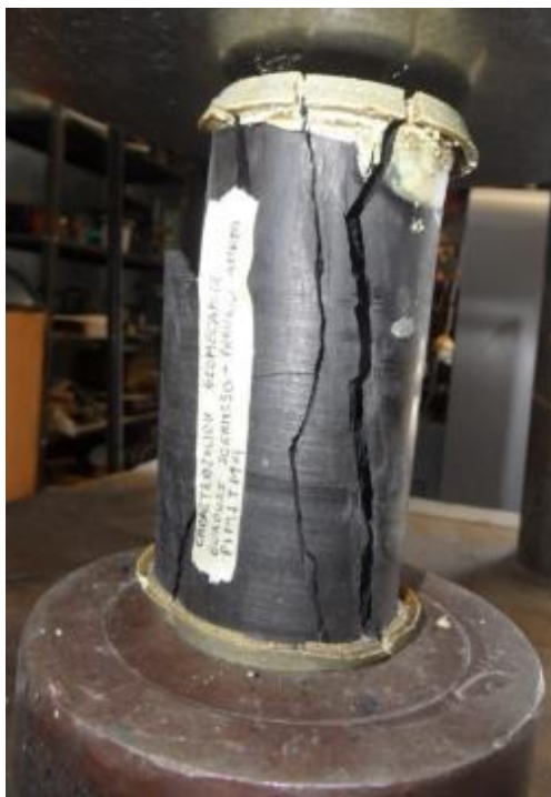
Foto 3. Rotura de probeta en carbón- ensayo de compresión simple.
