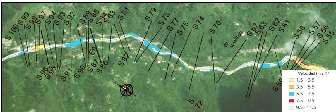
Figura 61. Velocidades en el cauce secciones S100 a S 55 en escenario de Bosques
