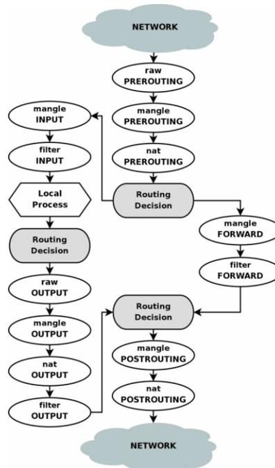
Por lo tanto, es necesario agregar las reglas a la tabla mangle en la etapa de prerouting, antes de las reglas para la configuración de Jool. De esta forma se hace un filtrado de paquetes, y el tráfico que no tenga reglas de filtrado saltará a la regla de Jool y será traducido normalmente.
