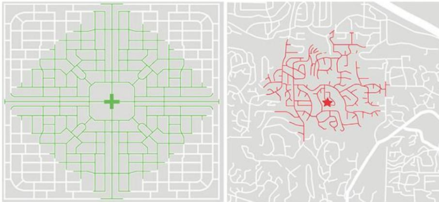
Comparación de una zona con un radio de 800 metros —zona de captación a pie— en diferentes configuraciones de conectividad vial (red compacta frente a un suburbio extendido).
