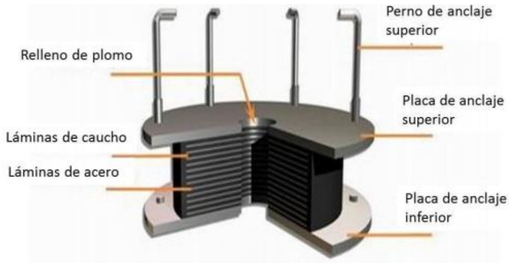
Ilustración 39 Aislador con núcleo de plomo
