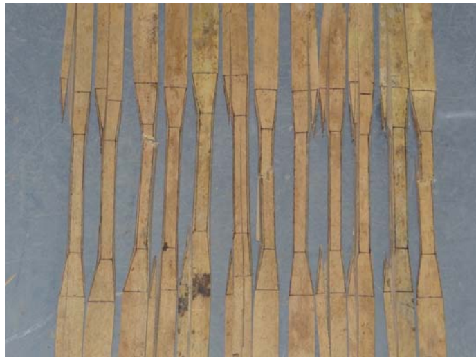
Fotografía 5.7 Probetas sin nudo falladas. Tracción paralela a la fibra
