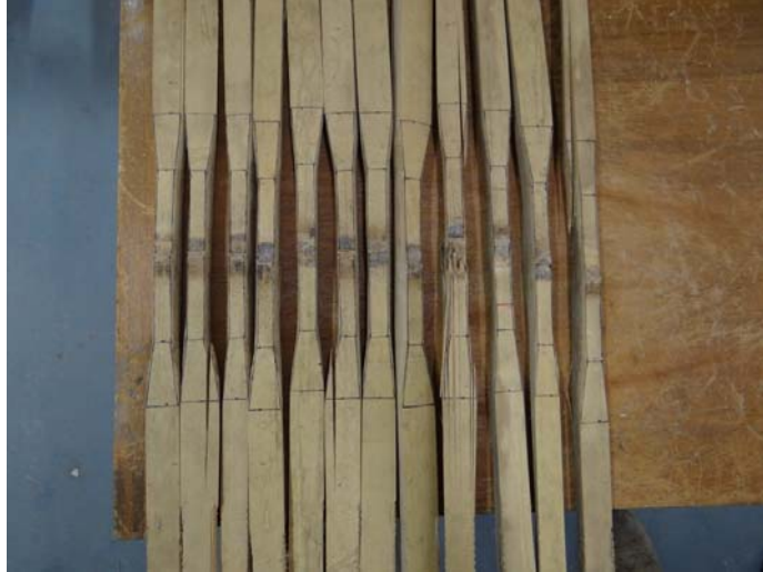
Fotografía 5.8 Probetas con nudo falladas. Tracción paralela a la fibra
