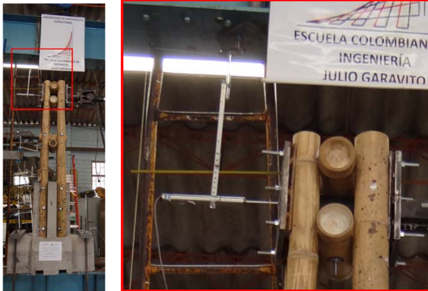
Fotografía 7.11 Detalle de la ubicación de los dispositivos LVDT en la posición 5
