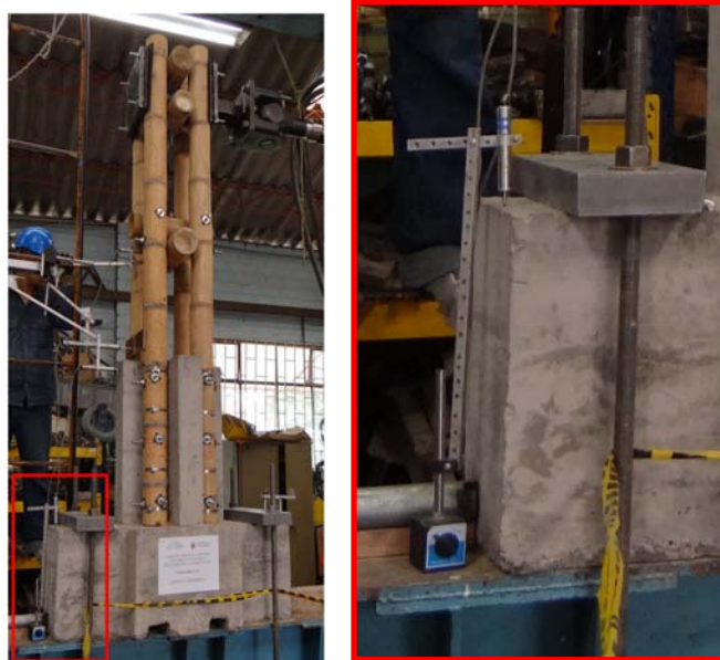
Fotografía 7.12 Detalle del dispositivo LVDT posición 1
