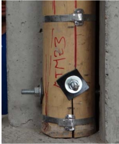
Fotografía 8.4 Falla por tracción diametral en un elemento con zuncho
