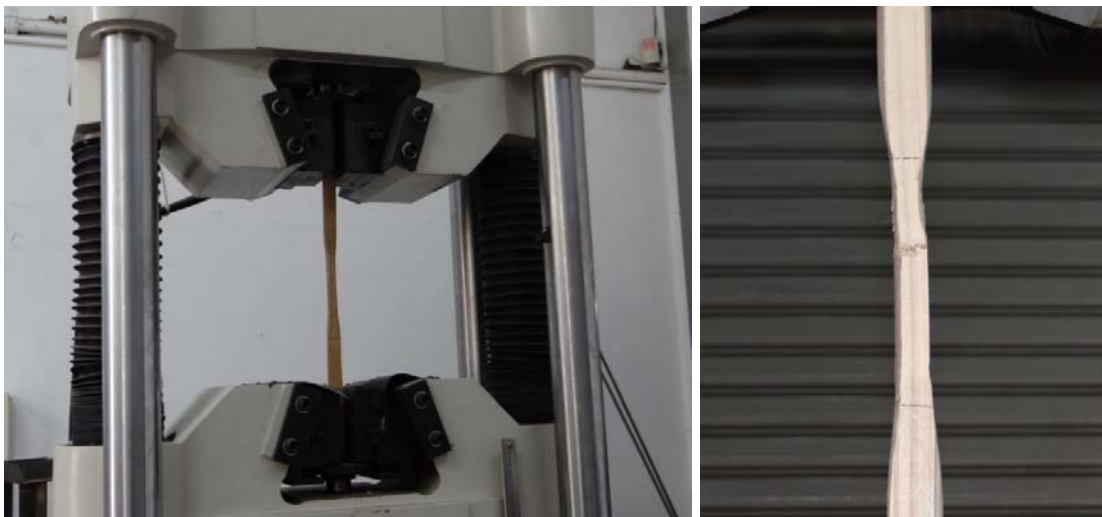
Fotografía 5.5 Montaje de ensayo. Tracción paralela a la fibra.
