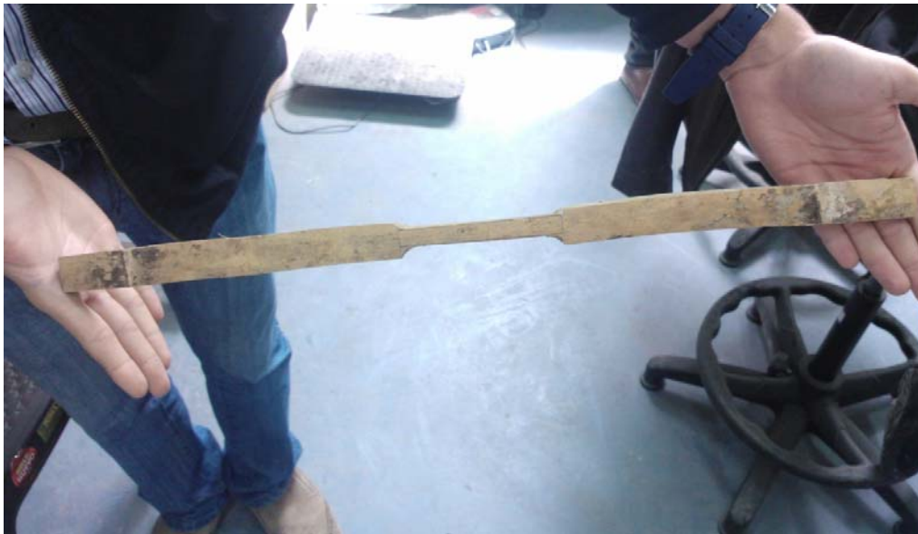
Fotografía 5.3 Probeta sin nudo en la porción de ensayo. Tracción paralela a la fibra.
