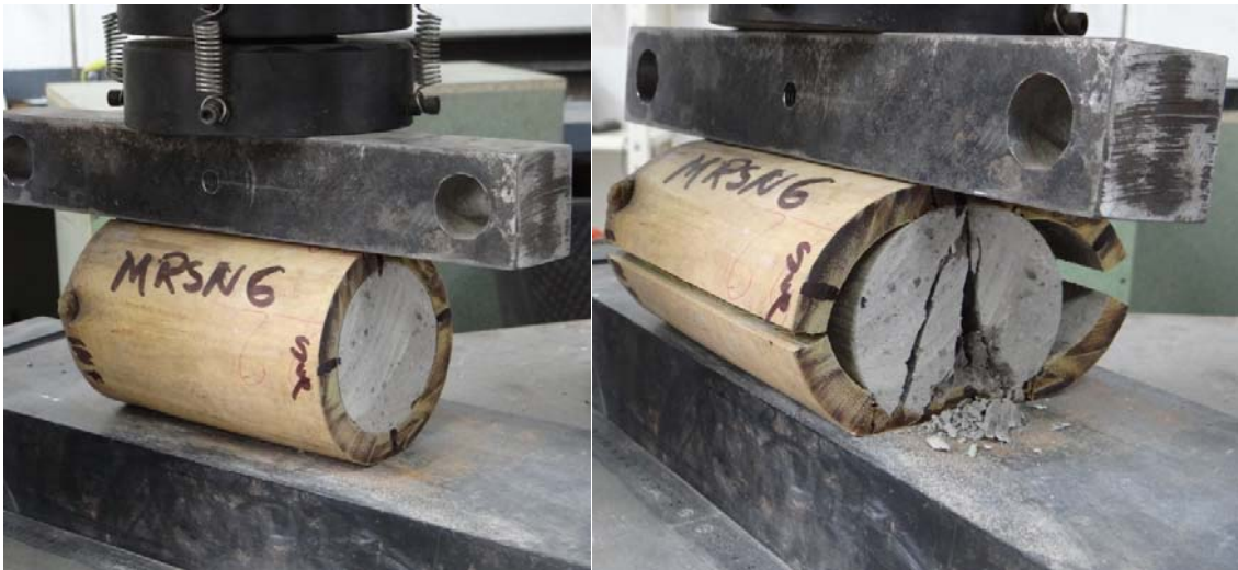
Fotografía 5.16 Compresión perpendicular a la fibra en probetas rellenas de mortero. a) Falla en probeta sin zuncho. b) Falla en probeta con zuncho.
