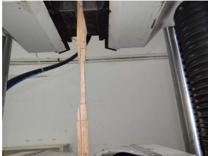
Fotografía 5.6 Ensayo de tracción paralela. Falla en la zona de transición.
