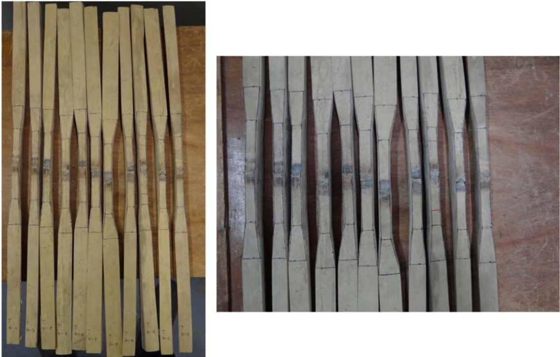
Fotografía 5.4 Probetas con nudo en la porción de ensayo. Tracción paralela a la fibra.
