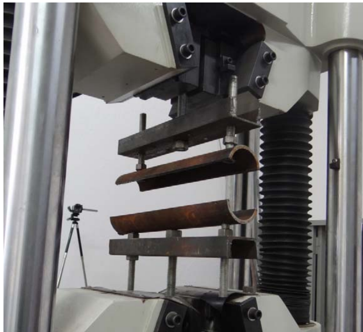
Fotografía 5.12 Dispositivo empleado en los ensayos de tracción perpendicular a la fibra
