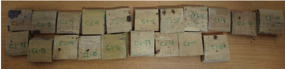
Fotografía 5.17 Probetas para el cálculo del contenido de humedad
