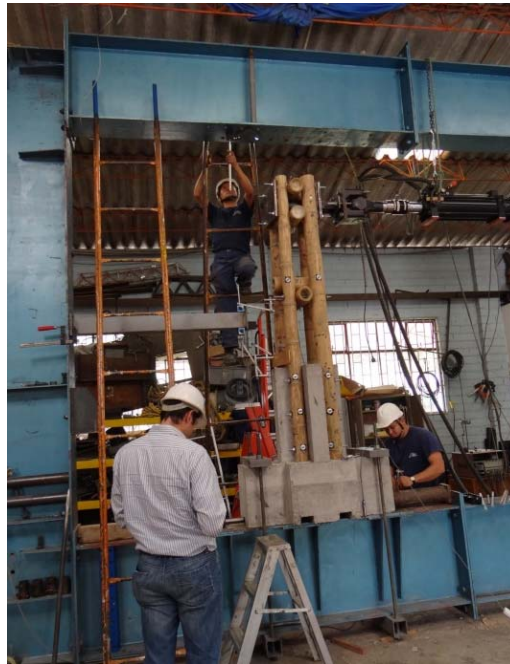
Fotografía 7.9 Instrumentación de un espécimen solicitado ante cargas monotónicas
