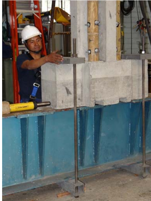
Fotografía 7.8 Soportes metálicos para restringir el giro de la vigas de centrado.
