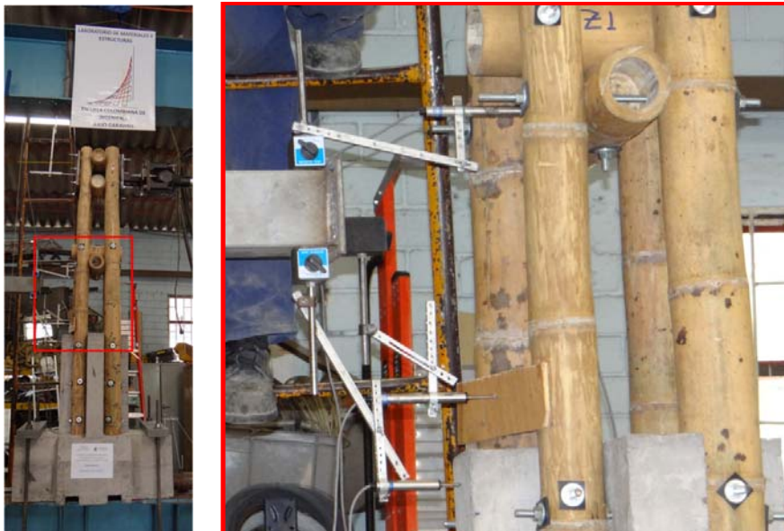
Fotografía 7.10 Detalle de la ubicación de los dispositivos LVDT en las posiciones 2 y 3
