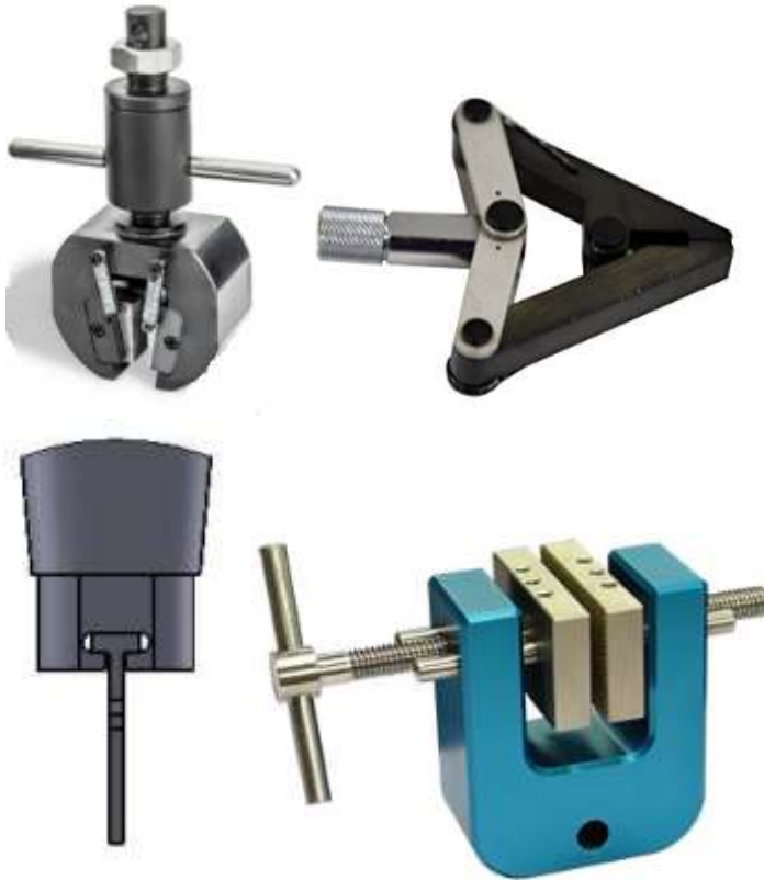
Figura 9. a) Mordaza tipo conica con superficie labrada [12], b) Mordaza tipo pinza [13], c) Mordaza de agarre por forma [14] y c) mordaza de agarra por forma variable [15].
