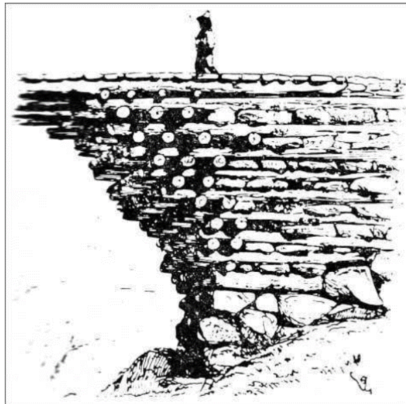
Figura 52. Puente de madera en voladizo (según Viollet le Duc). Fuente: tomada de la referencia (Mathivat, J., 1980).
