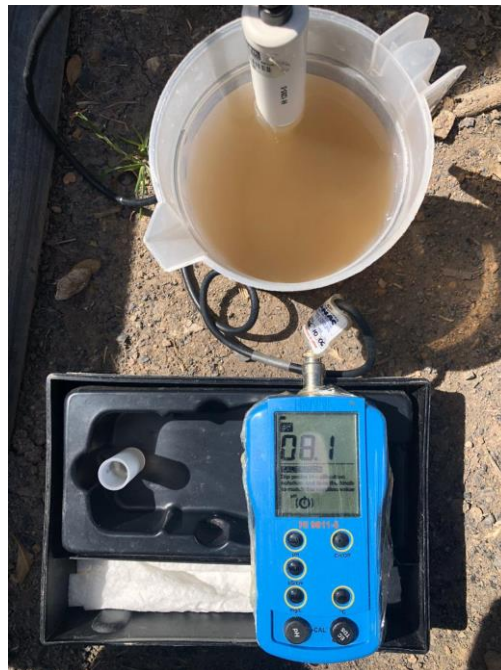
Ilustración 16. Medición de pH
