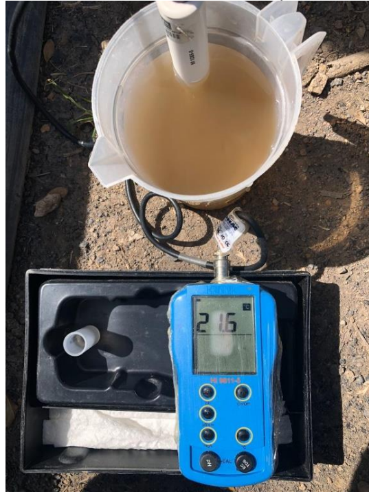
Ilustración 15. Medición de temperatura
