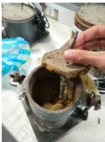
Figura 14 Preparación en seco y humedecimiento en la superficie.
