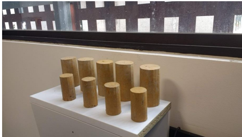
Figura 33 Probetas a diferentes contenidos de humedad para ensayo de compresión inconfiada. Se ensayaron 7 muestras en la máquina de compresión inconfiada a una velocidad de 1.04 mm/min. Los ensayos se realizaron con rangos de succión similares a los obtenidos en los ensayos de capacidad portante. En la Figura 34 se muestran los resultados obtenidos para diferentes valores de succión, se puede observar que los valores de
