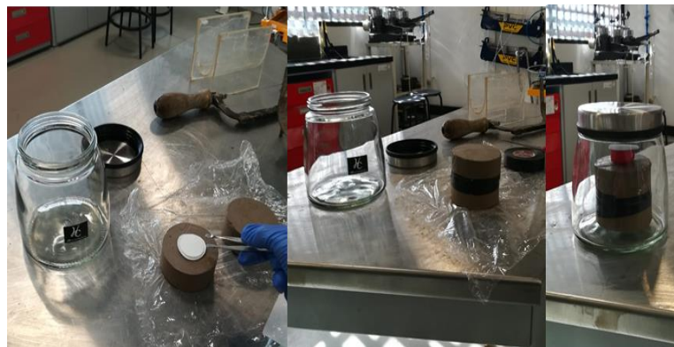
Figura 20 Montaje del ensayo de papel filtro
