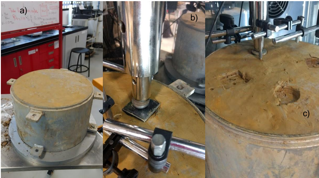
Figura 23 Procedimiento para ensayos de capacidad portante a) Montaje b) aplicación de carga c) distribución de ensayos en la muestra.
