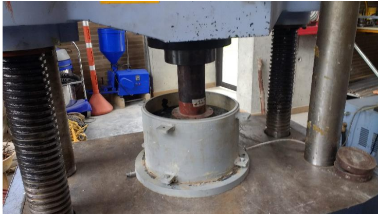
Figura 43 Compactación de muestra en el Laboratorio de Estructuras
