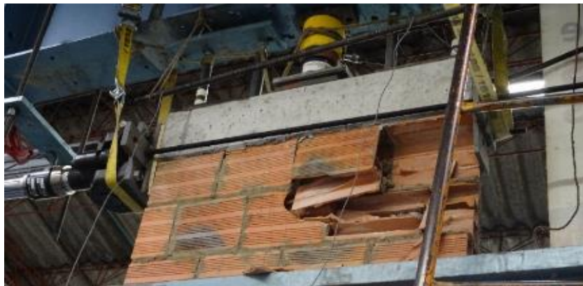
Figura 97. Falla por rotura de bloques en muro MC2 PD.
