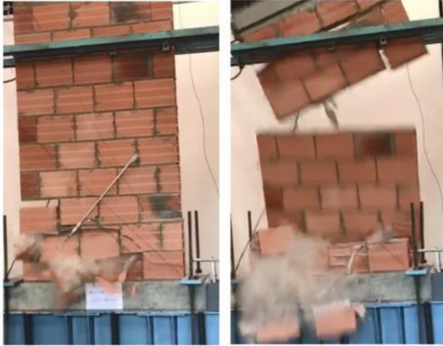
Figura 96. Falla de muro MC1 PD por rotura en zona inferior.
