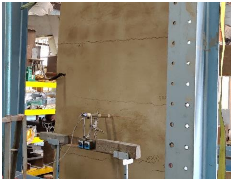
Figura 109. Fisuración en pañete por flexión fuera del muro.
