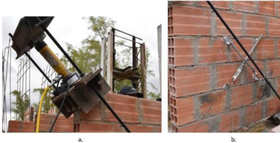
Figura 69. a. Sistema de aplicación de carga; b. Instrumentación del espécimen.
