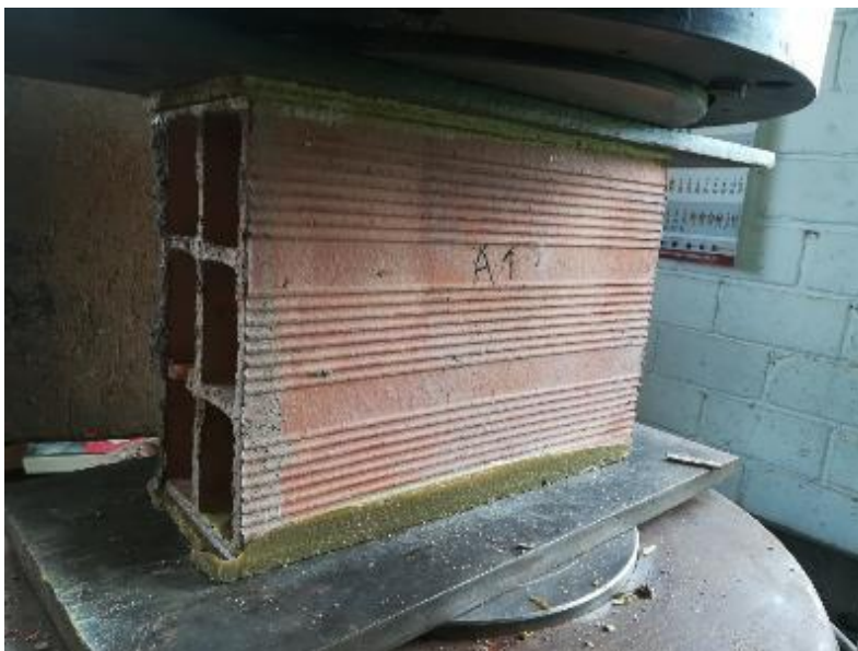
Figura 66. Ensayo de compresión en unidades de mampostería.
