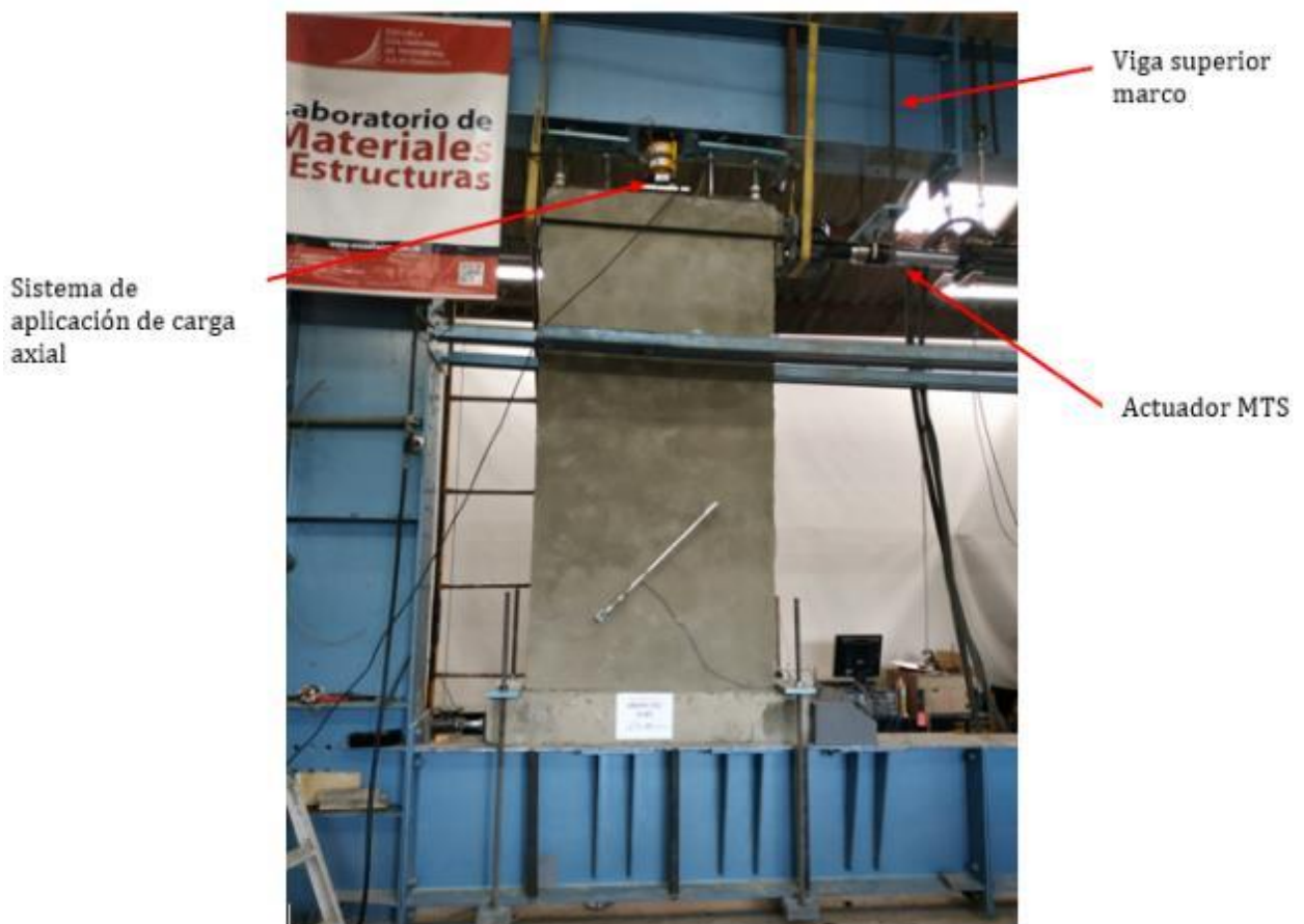
Figura 76. Montaje para ensayo de carga lateral cíclica en muros.
