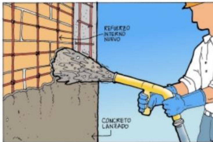
Figura 58. Revestimiento de muro de mampostería (AIS, 2004).
