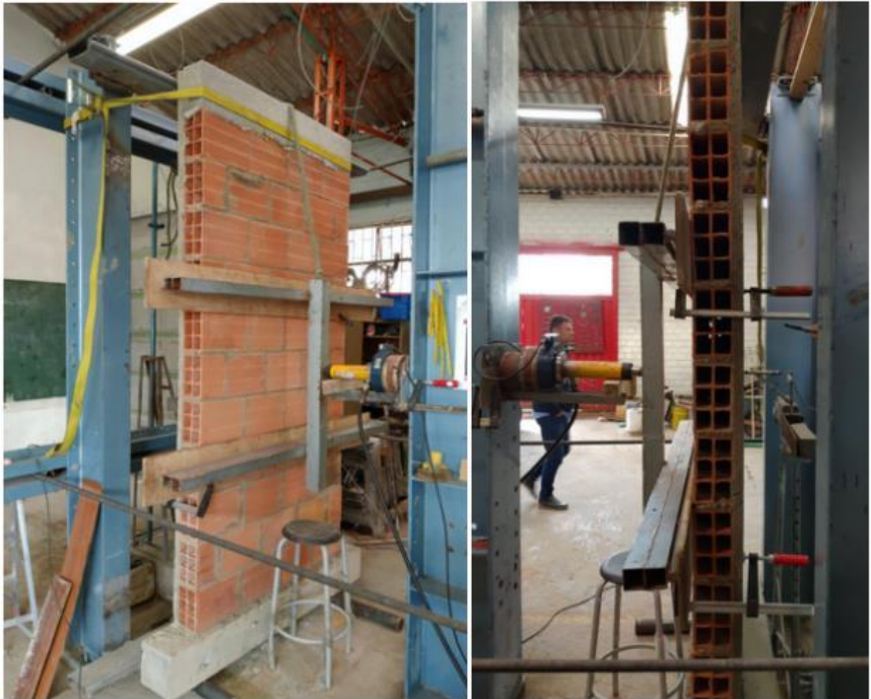
Figura 84. Montaje para ensayo de flexión fuera del plano.
