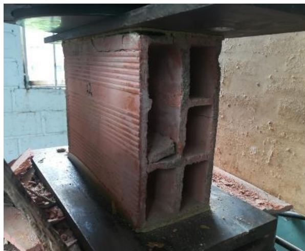
Figura 85. Falla de unidad de mampostería por compresión axial.
