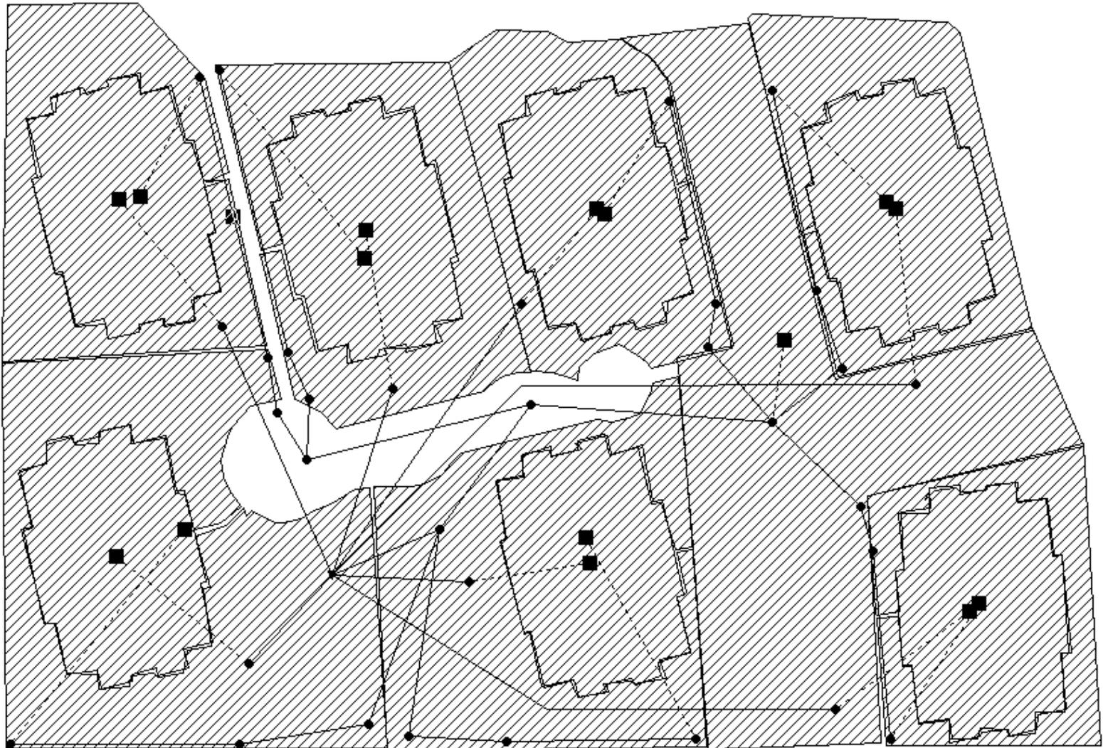
Figura 53 – Distribución general de la red de drenaje pluvial – Diámetros definitivos
