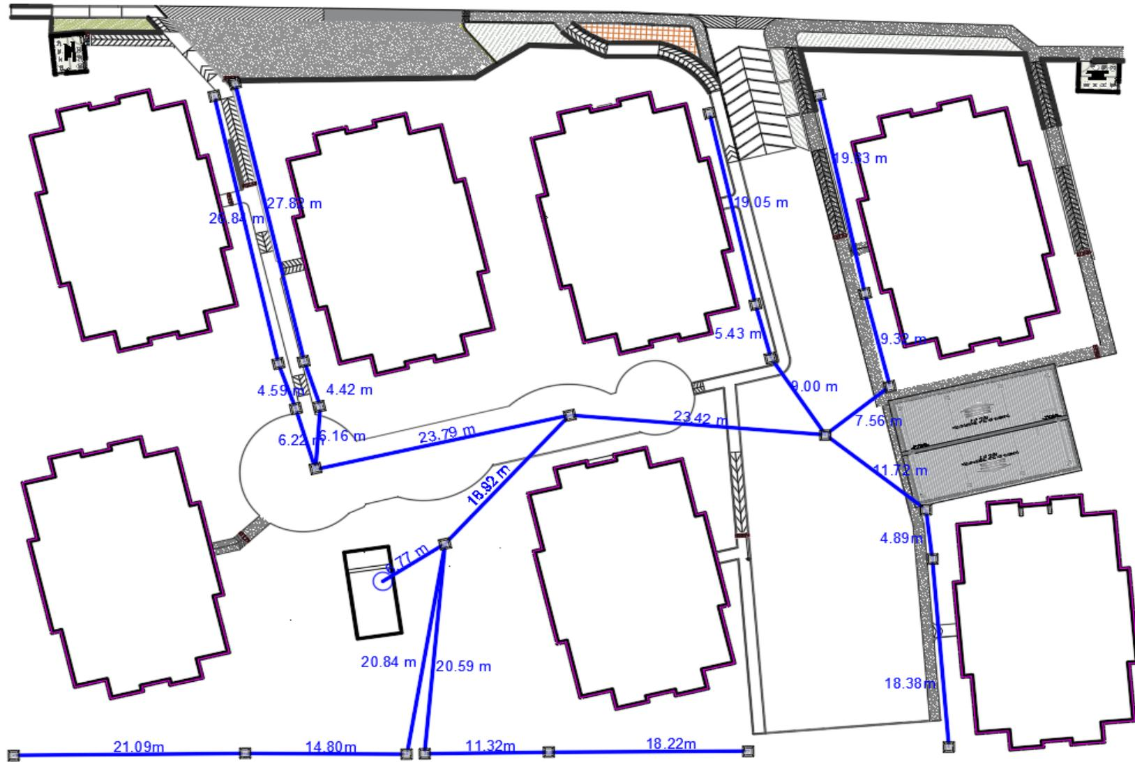
Figura 52 – Distribución general de la red de drenaje pluvial – SWMM – Con base a Figura 51
