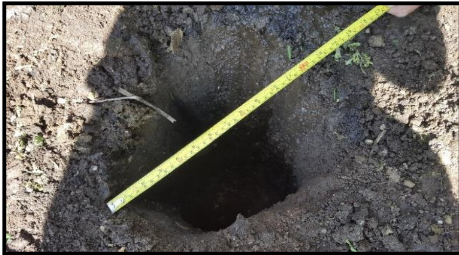
Figura No. 17 Hueco 1 con un ancho de 30 cm en promedio. Fuente: Propia
