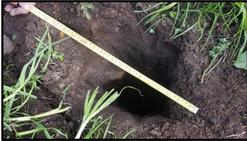
Figura No. 19 Hueco 2 con un ancho de 30 cm en promedio. Fuente: Propia
