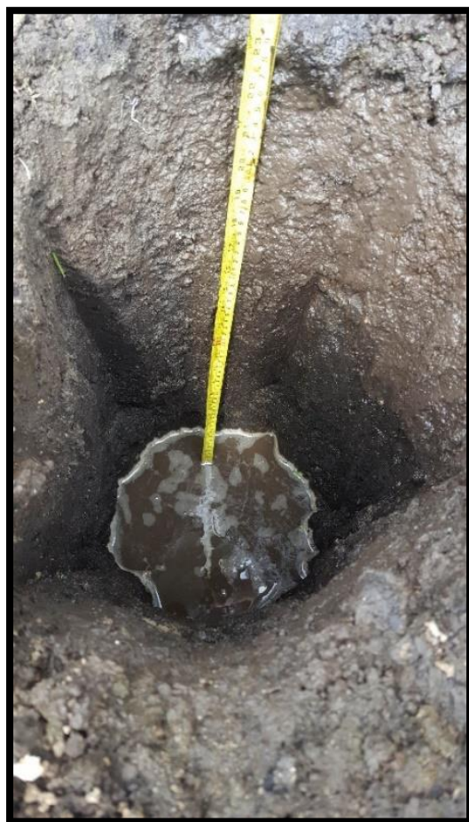
Figura No. 25 Medición de la caída del agua cada 30 min. Fuente: Propia
