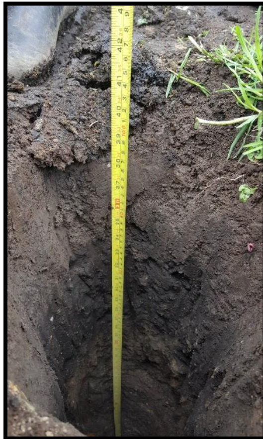
Figura No. 20 Hueco 2 con una profundidad de 1 m. Fuente: Propia
