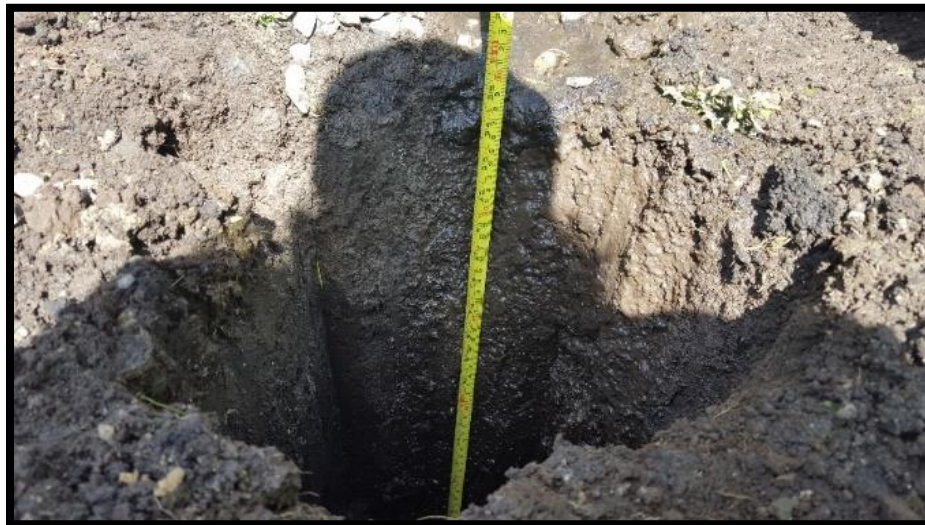
Figura No. 18 Hueco 1 con una profundidad de 1 m. Fuente: Propia
