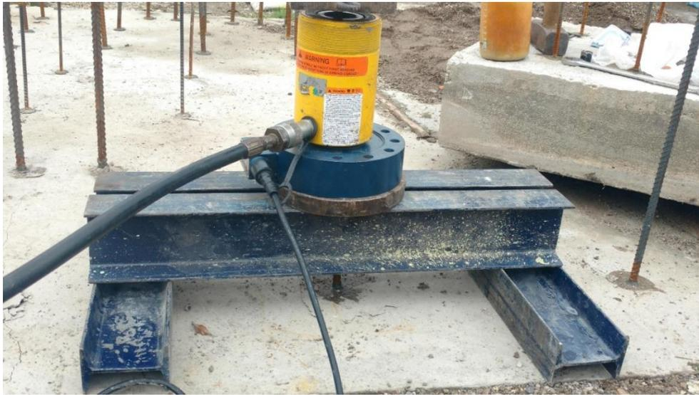
Figura 27. Montaje ensayo no confinado a tracción.
