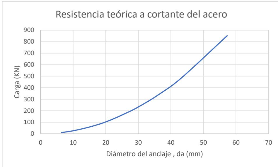
Figura 58. Resistencia teórica a cortante del acero ASTM A-706.
