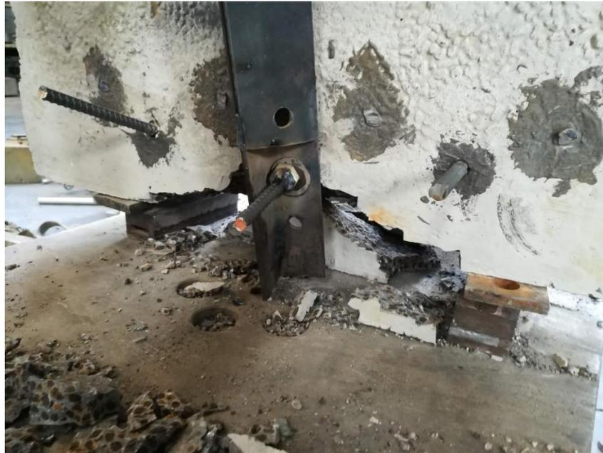
Figura 64. Falla del concreto y acero en ensayos a cortante.
