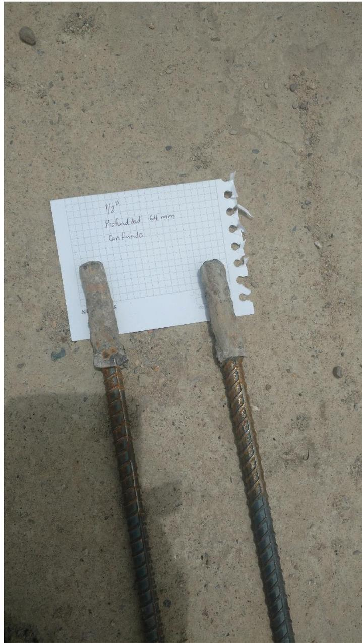
*Figura 60. Falla por adherencia en ensayos confinados a tensión.*
