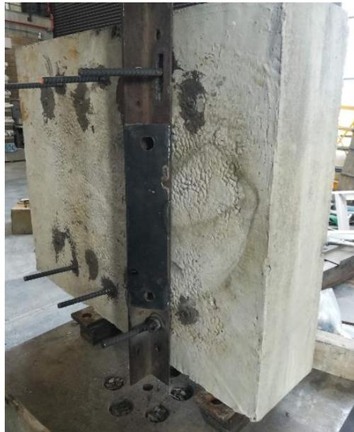
*Figura 26. Anclajes en losa a cortante.*
