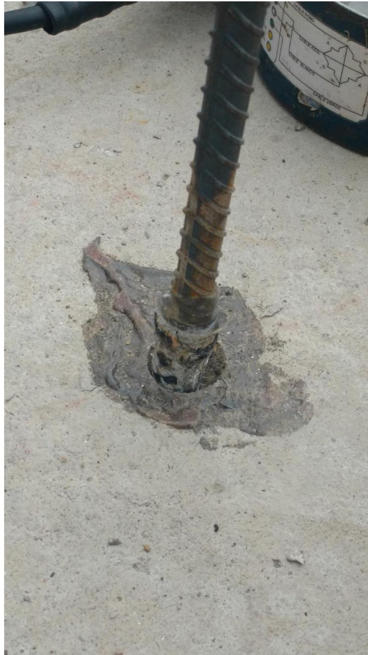
*Figura 61. Falla por adherencia en ensayos confinados a tensión.*
