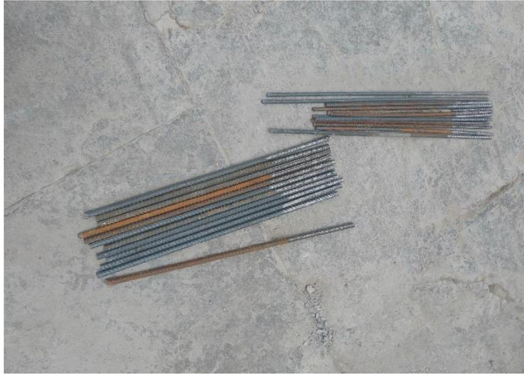
*Figura 23. Varillas después de la limpieza.*
