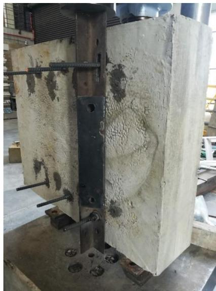
Figura 29. Montaje ensayo a cortante.
