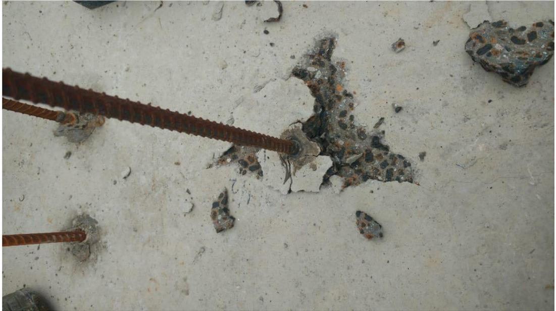
*Figura 62. Falla del concreto en ensayos no confinados a tensión.*
