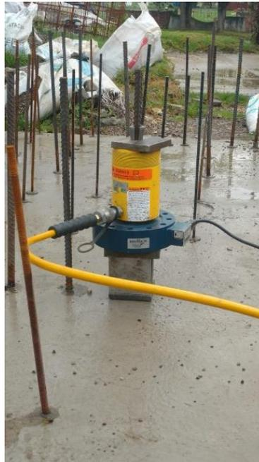
Figura 28. Montaje ensayo confinados a tracción.
