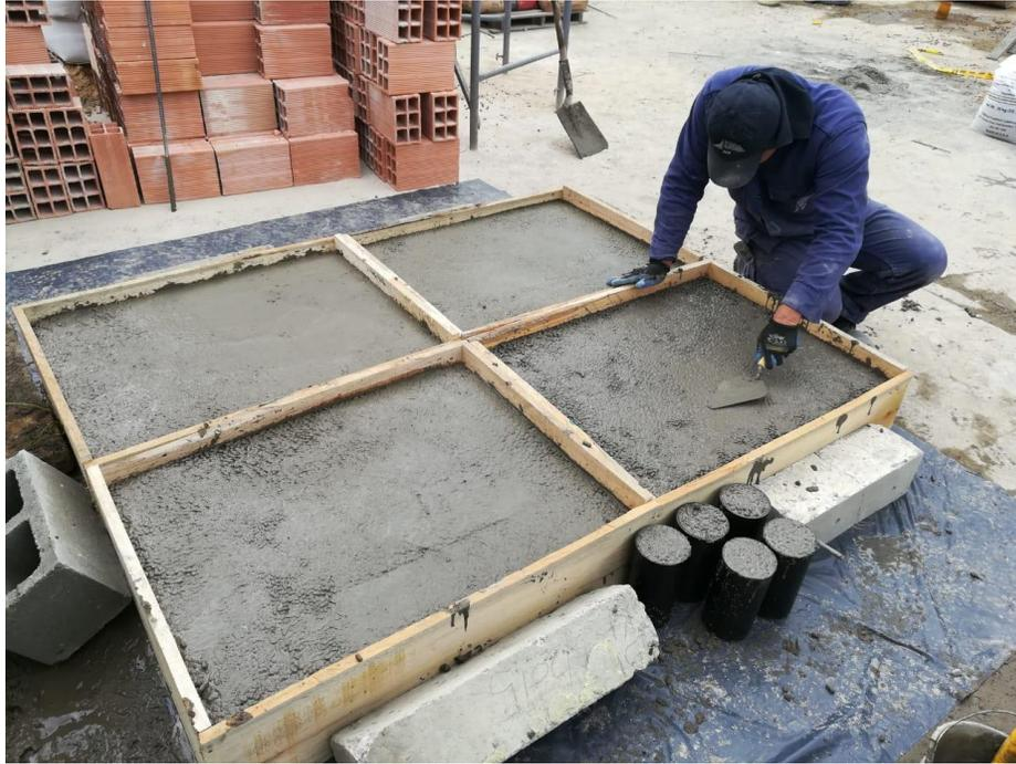
*Figura 16. Losas fundidas para ensayos a cortante.*
