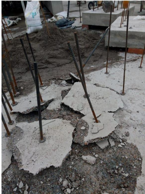
*Figura 63. Falla del concreto en ensayos no confinados a tensión.*
