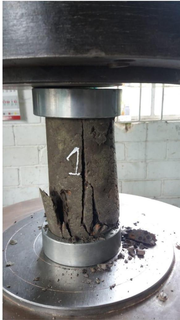
*Figura 13. Prueba de resistencia del concreto.*
