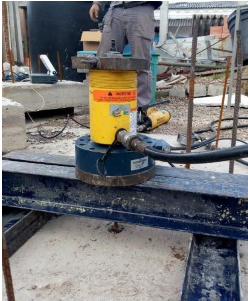
Fotografía 2. Montaje experimental para ensayos a tracción no confinada. *Fuente: Propia.
