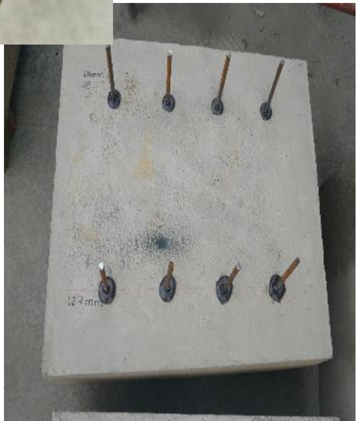
Fotografía 12. Instalación de barras enroscadas en placas de prueba.
