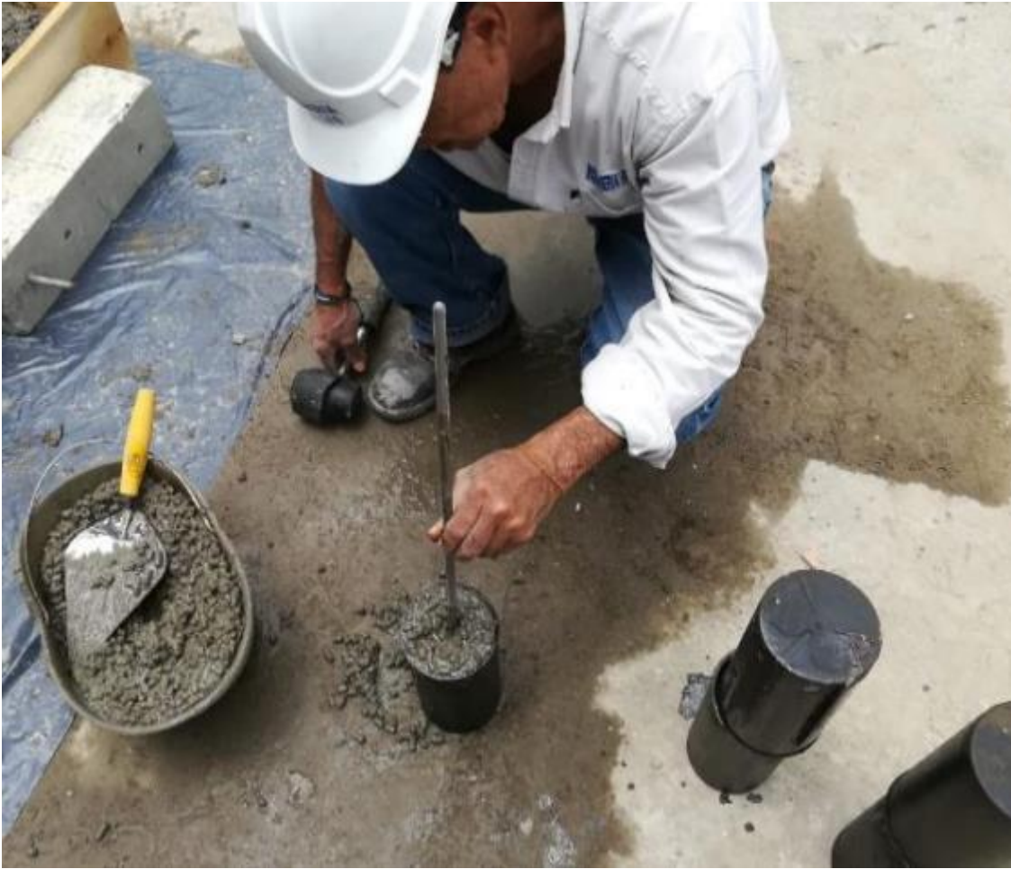
Fotografía 17.Elaboración de probetas de concreto. *Fuente: Propia
