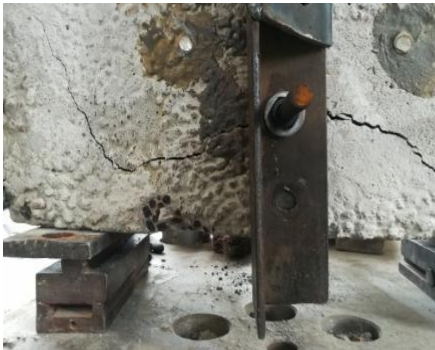
Fotografía 25. Falla por arrancamiento del concreto M2 – 1 / 2". *Fuente: Propia.
