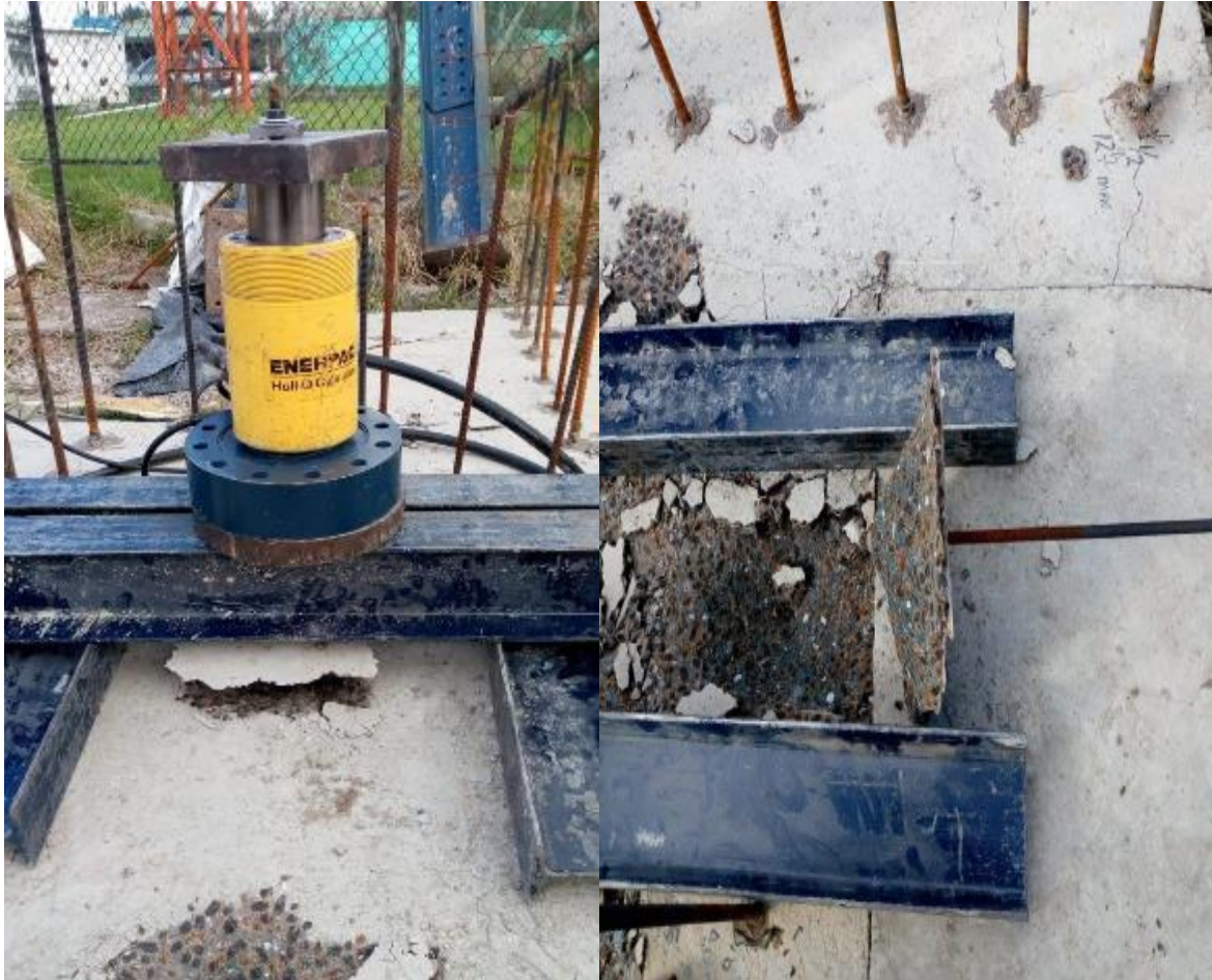
Ilustración 28. Falla por arrancamiento del concreto. *Fuente: Propia.
