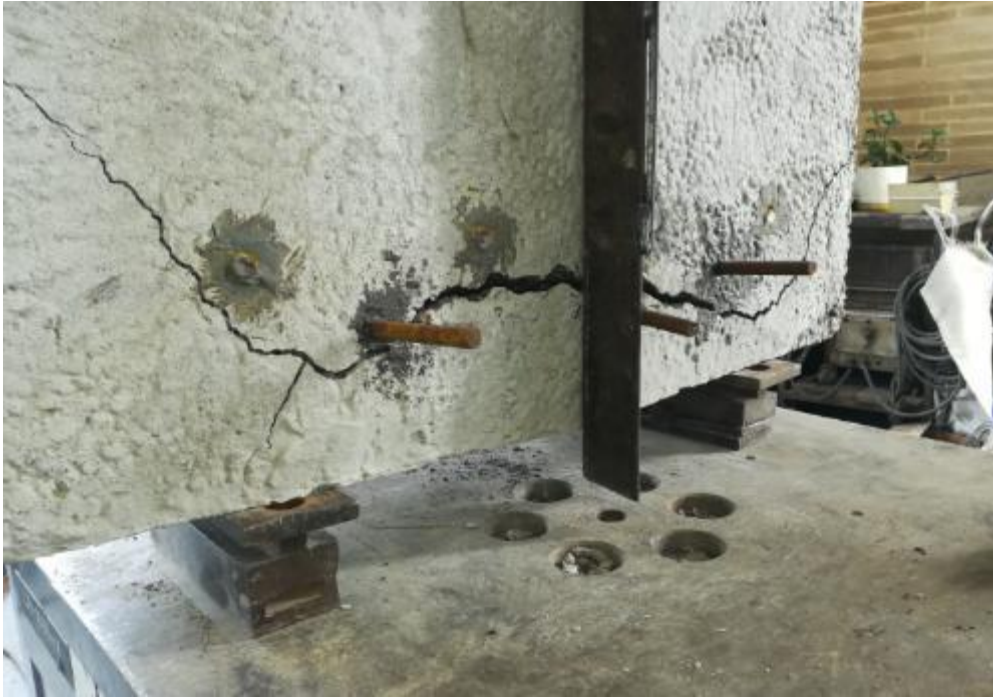
Fotografía 26. Falla por arrancamiento del concreto M3 – 1/2". *Fuente: Propia.
