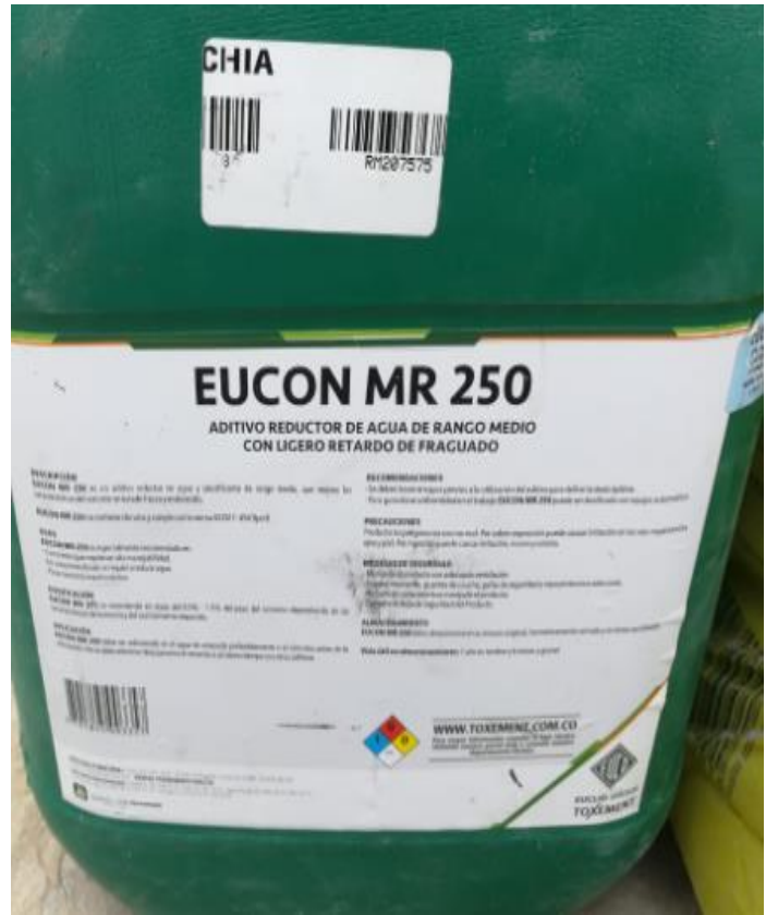
Fotografía 4. Materiales utilizados en la elaboración de placas en concreto liviano: a) agregado liviano agregado LIVITEK, b) arena y c) Aditivo reductor de agua de rango medio con ligero retardo de fraguado. Y cemento portland de uso general.
