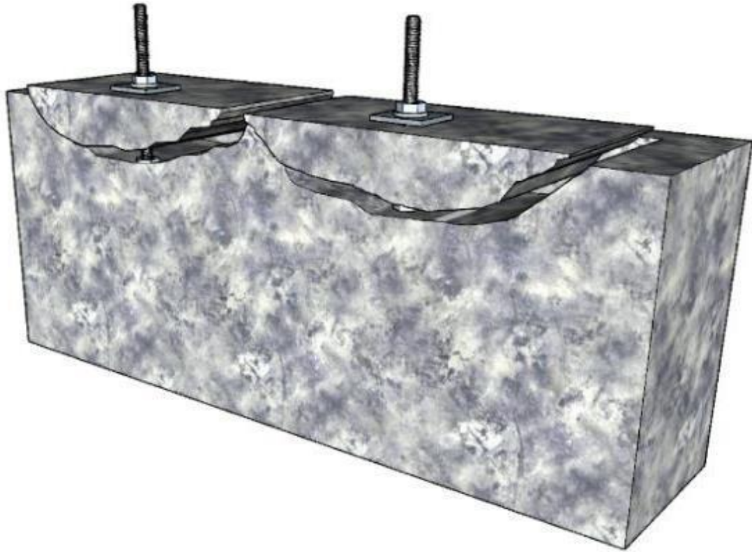
Ilustración 16. Arrancamiento del concreto - tracción. * Fuente: Propia.
