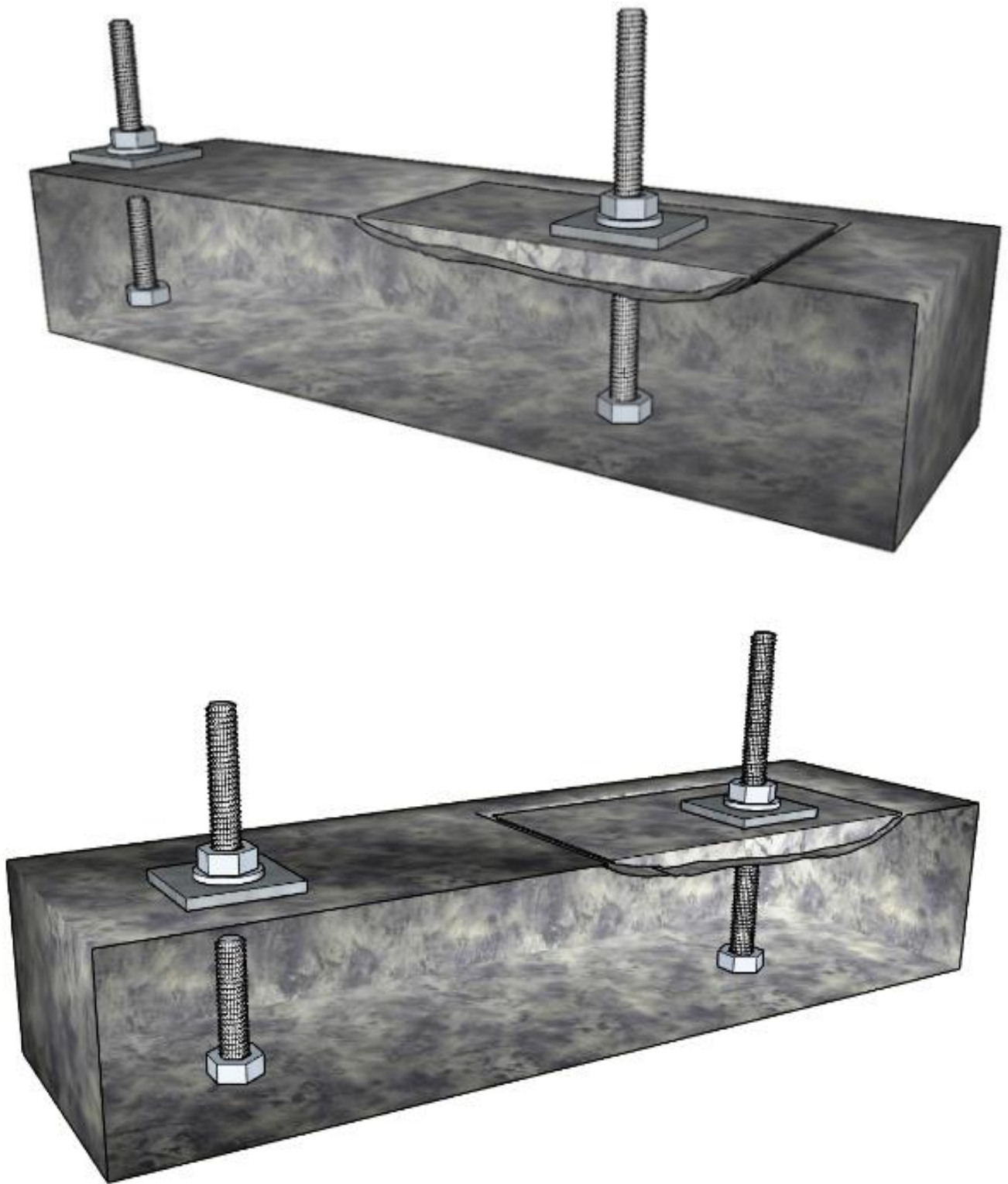
Ilustración 13. Falla del acero y desprendimiento. * Fuente: Propia.
