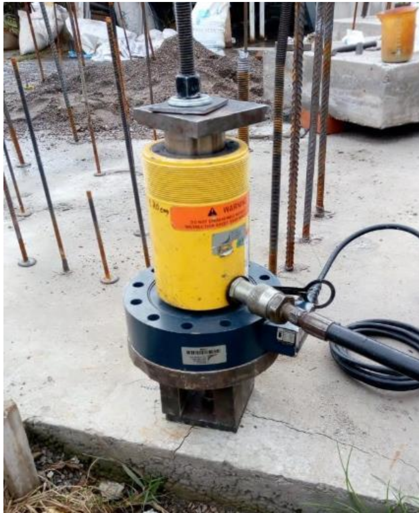
Fotografía 1. Montaje experimental para ensayos a tracción confinada. *Fuente: Propia.
