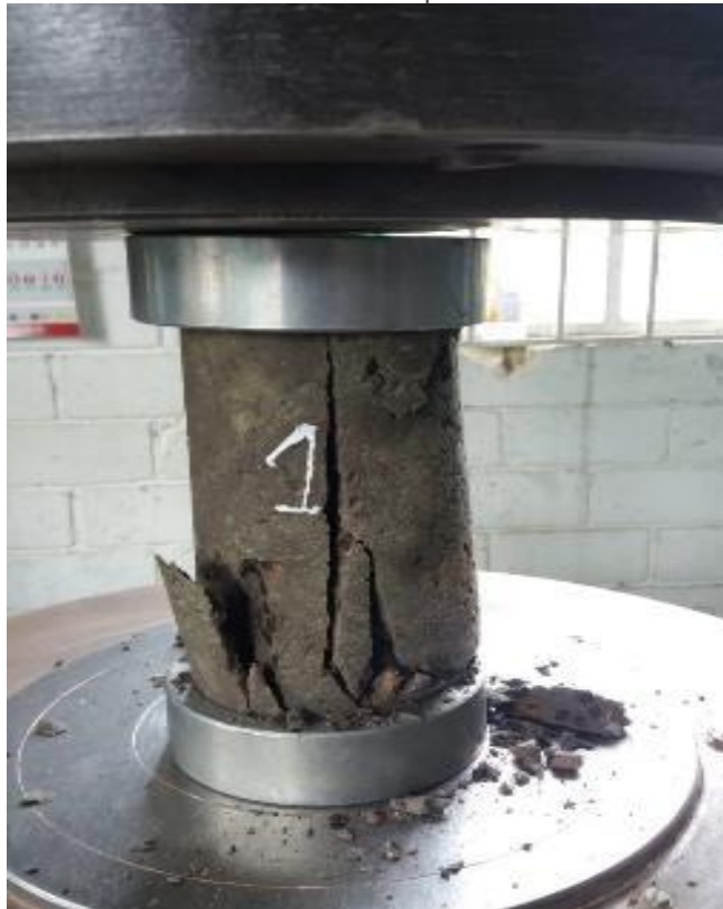
Fotografía 5. Ensayo para determinar la resistencia a la compresión del concreto aligerado.
