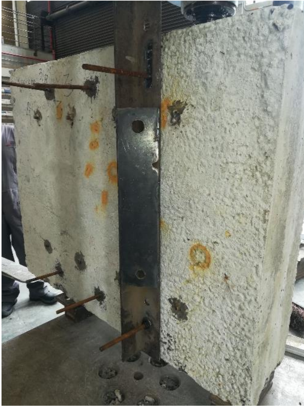
Fotografía 3. Montaje experimental de ensayo a cortante en maquina universal. *Fuente: Propia.
