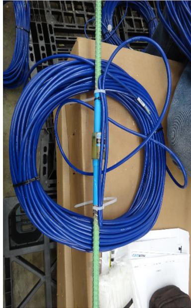
**Fotografía 7.** Galga extensiométrica de cuerda vibrante
