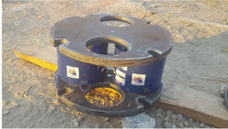
**Fotografía 6.** Batería de Celdas Osterberg Soldadas a las platinas superior e inferior.
