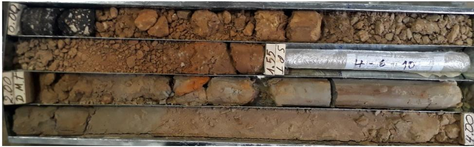
**Fotografía 1.** Caja de perforación indicando profundidades entre 0,00 y 4,00 m.
