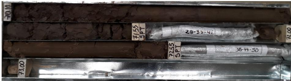
**Fotografía 5.** Caja de perforación indicando profundidades entre 70,10 y 73,00 m
