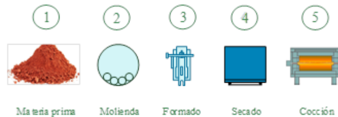
Figura 1-2 Proceso productivo del ladrillo. Fuente: Elaboración propia
