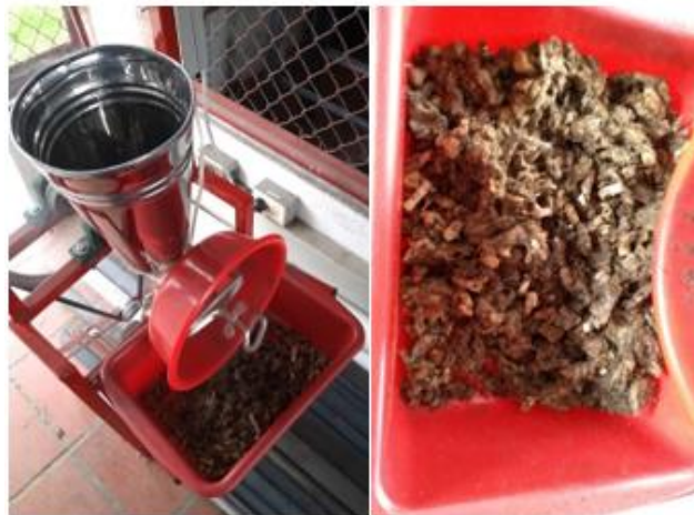
Figura 2-2 Molino y colillas de cigarrillo molturadas. Fuente: Elaboración propia.
