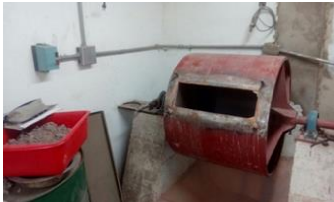
Figura 2-1 Máquina de los Ángeles. Fuente: Elaboración propia
