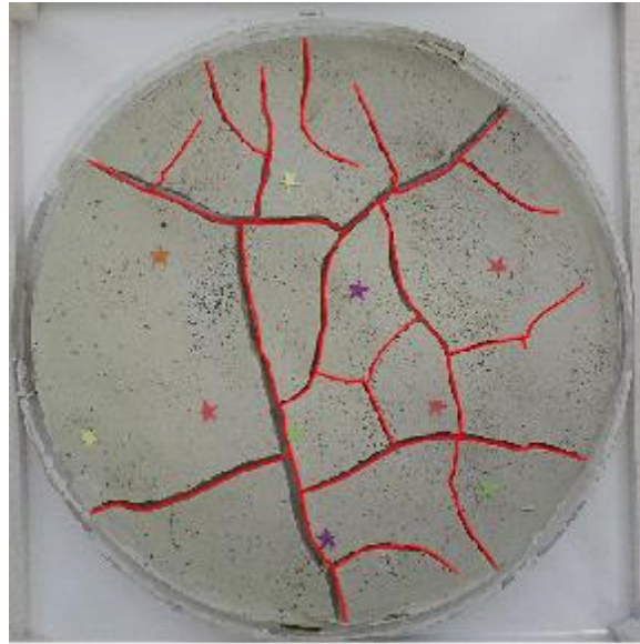
Ilustración 12 Longitud de las fisuras, muestra #3
