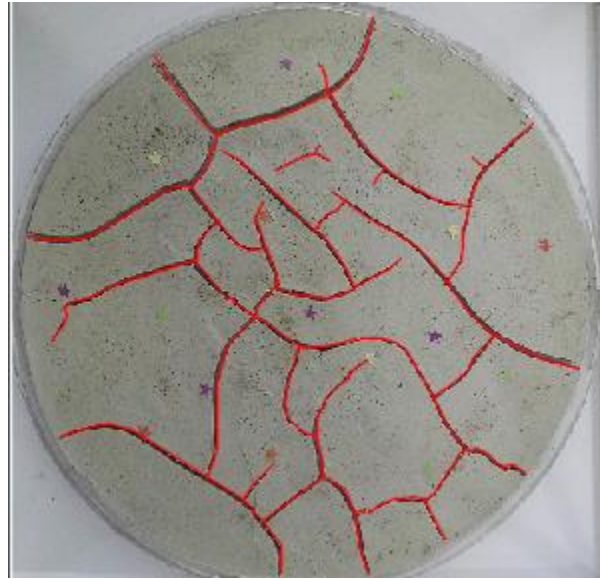
Ilustración 13 Longitud de la fisura, muestra #4
